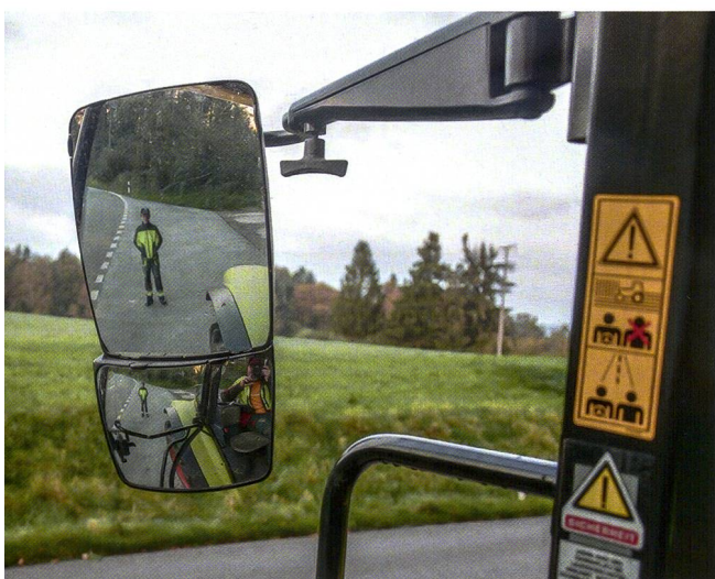
Verbessert das Sichtfeld: Hauptspiegel kombiniert mit einem kleineren Weitwinkelspiegel.
