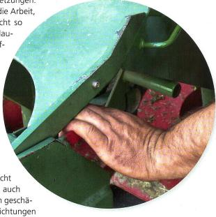
Grundsätzlich muss jede Maschine so gebaut sein, dass Betriebsstörungen möglichst ausgeschlossen sind. Wenn zur Pannenbehebung Schutzvorrichtungen entfernt werden, müssen diese anschliessend umgehend wieder montiert werden. An Quetschstellen ereignen sich immer wieder schwere Finger- oder Handverletzungen.
