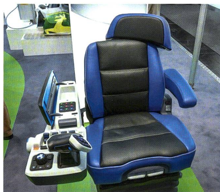
Neuer Sitz mit semiaktiv geregelter Seitenhorizontalfederung und adaptiver Rückenunterstützung.
