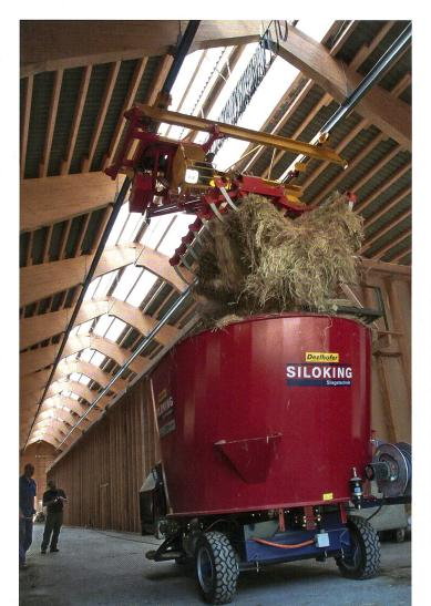
**Futtermischwagen** sollen stets indirekt befüllt werden. Dazu eignen sich Hebefahrzeuge, Krananlagen oder Förderbänder. Falls von oben beschickt wird, muss iede Sturzmöglichkeit ausgeschlossen werden. Das Hineinfallen in einen laufenden Mischwagen endet mit schwersten Verletzungen oder gar tödlich.
