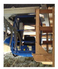
Betriebseinrichtungen müssen gemäss Bundesgesetz über die Sicherheit von technischen Einrichtungen und Geräten (STEG) betriebssicher gebaut und angeordnet sein. Das bedeutet auch, dass der Aufstieg zum Podest und der Übertritt in die Krankabine vollständig geschützt sein müssen.
