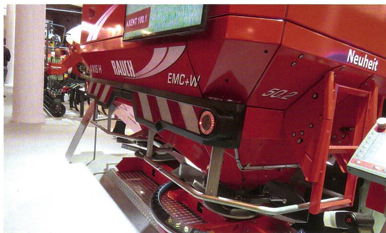
«Axmat plus» von Rauch verfügt über 27 Radarsensoren, die kreisförmig unterhalb der Düngerstreuer-Wurfscheiben positioniert sind. Nach dem Scannen erkennt die Software Lage, Charakter und Expansion des Streubildes. Bild: Roman Engeler
