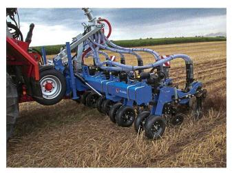
Die streifenweise Bearbeitung kombiniert die Vorteile einer konventionellen mit jenen einer konservierenden Bodenbearbeitung. Bild: zvg
