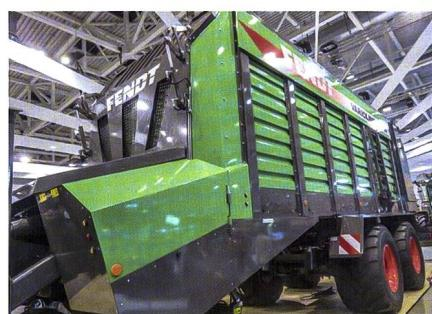
Merkmale, so eine extern zu bedienende Knickdeichsel oder eine verschiebbare, mit dem Erntegut mitlaufende Stauwand. Der Markteintritt hat Fendt für 2017 geplant. Zusammen mit den Mähdreschern der verschiedenen Serien, dem Feldhäcksler «Kataina», den Grosspackenpressen sowie den Futtererntegeräten Mähwerke, Kreisler und
