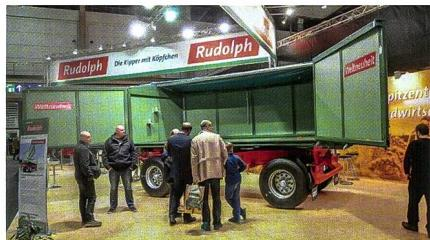
wenn Waren auf Paletten oder in Paloxen transportiert werden sollen. Die Seitentüren dienen als Ladungssicherung auch für weitere Ladegüter wie Grossballen. In Kombination mit der Abdeckung und der Kippbrücke ermöglicht dieser Anhänger eine bisher unerreichte Vielfalt an Einsatzflexibilität für landwirtschaftliche Transporte.
