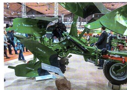
stehen, über neue Pflugkörper mit hydraulischer Steinsicherung beim «Cayron 200» bis hin zu Hightech aus dem Baumarkt in Form von Gummimatten, mit denen über eine Smartphone-App die Querverteilung und Ausbringmenge eines Düngerstreuers einfach erfassen kann («EasyCheck»).
