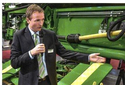
«Zürn Harvesting», am Messestand. Alle Komponenten am Schneidwerk sind elektrisch angetrieben. In ihrer Doppelfunktion als Antrieb und Sensor sind Elektromotoren präzise regelbar, was Drehzahl und Drehmoment betrifft. Darüber hinaus liefern sie in der Funktion als Sensor wertvolle Informationen über Belastungszustand und Einsatzbedingungen. Laut Firmenchef, biete das Niederspannungs-Antriebssystem (60V) hohe Sicherheit, und dies unter allen Wittringsbedingungen.
