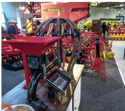
Väderstad präsentierte das mit dem ungarischen Partner Digitroll entwickelte System zur Ermittlung der Samenanzahl. «SeedEye» ist einsetzbar an den Sämaschinen «Spirit R» und «Rapid A». Der Fahrer definiert die Anzahl Körner pro Quadratmeter, die Kalibrierung und alles weitere übernimmt die Maschine automatisch. Im Übrigen standen Tempo, Präzision und Kapazität bei
