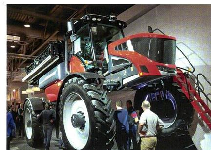
Diese würden hier das Gestänge nachregeln, obwohl kein Bedarf besteht. Anders beim lasergestützten vorausschauenden Erkennungssystem zur Gestängesteuerung von Horsch: Hier wird ein Laserscanner auf dem Kabinendach montiert, der das Umfeld nach
