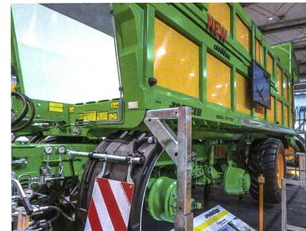
Seit nunmehr etwas mehr als 30 Jahren ist Joskin dynamisch unterwegs – diese Dynamik setzte das belgische Unternehmen nun auch mit einem dynamischen Wiegesystem für seine Transport- und Ausbringanhänger um. Mittel zweier Drucksensoren am Fahrwerk und über einen Sensor auf der Deichselfederung kann das Gewicht per Funk in den Traktor oder ein Ladefahrzeug übermittelt werden. Weiter zeigte Joskin ein «E-Drive»-Konzept mit elektrisch gesteuerten Antriebsachsen.
