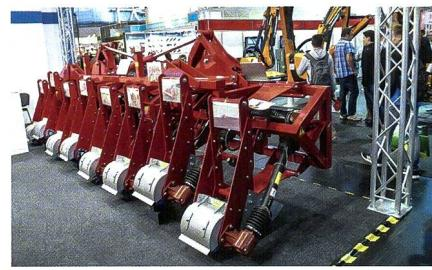
der Lebensraum des Maiszündlers auch bei Unebenheiten und in Fahrspuren vollständig zerstört. Der Treibstoffverbrauch soll zudem wesentlich geringer sein als beim ganzflächigen Fräsen. Der Antrieb der Rotoren kann mechanisch oder hydraulisch gewählt werden.
