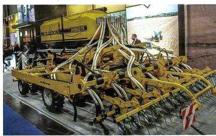
Verfahren als «Streifen-Direktsaat», denn der Boden kann dank einer grossen Auswahl an unterschiedlichen Werkzeugen weniger oder mehr bearbeitet werden. Die Bezeichnung «Hybrid» stammt daher, dass Saatgut sowohl in unbearbeiteten, minimal bearbeiteten als auch gepflügten Boden eingebracht werden kann. Das soll es den Landwirten ermöglichen, eine grosse Vielfalt an Arbeitsgängen mit einer minimalen Investition und wenig Treibstoff ab 10l/ha zu erledigen.
