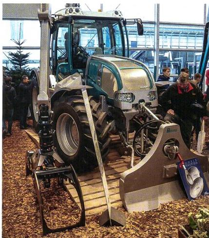
eine Erhöhung der Standstabilität, die Panoramakabine mit um 340° elektrisch drehbarem Bedienerstand ermöglicht Arbeiten mit optimaler Sicht und ergonomischer Bedienung.
