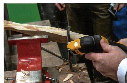
kommen. Das Doppelmesser kann an ein handelsübliches Multifunktions-Vibrations-Gerät angebaut werden. Die Hauptvorteile sind, dass keine Wärme und kein Staub entsteht und man folglich ohne Brille arbeiten kann. Weiter dürften das geringe Gewicht und die kleine Bauform des Doppelmessers eine bessere Zugänglichkeit und Beweglichkeit ermöglichen als der Winkelschleifer.
