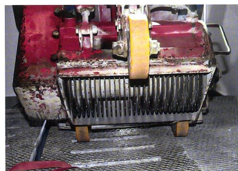
Das Schlitzfräsverfahren ermöglicht eine nachhaltige Verbesserung der Trittsicherheit.
