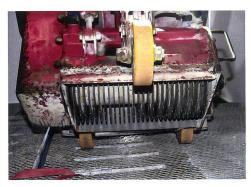
Das Schlitzfräsverfahren ermöglicht eine nachhaltige Verbesserung der Trittsicherheit.
