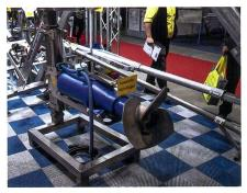
Das neue «Orka»-Tauchmotorrührwerk rührt in beide Richtungen.
