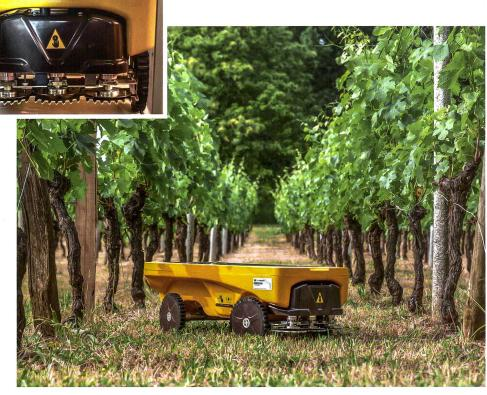
gebrauch ausreichend ist. Bei noch intensiverer Nutzung versorgt zusätzlich ein Lithium-Ionen-Akku den Roboter, der an einer Ladestation während zwölf Stunden aufgeladen werden muss. Die Autonomie ist dann über 20 Stunden auch ohne Sonneneinstrahlung gewährleistet.
