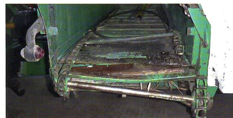
Die Laufschiene mit Kettenantrieb für die Querverschiebung an der Front ist deformiert.
