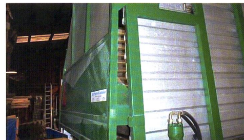
Die Heckklappe schliesst nicht mehr.
