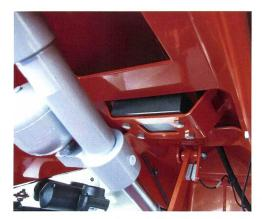
Diese Sensoren unter dem Behälter erfassen die Hangneigung und die durch holprige Fahrt erzeugte Beschleunigung (Fehlerkorrektur der Waage).
