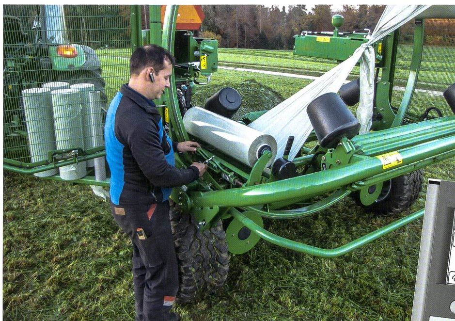
Der Folienwechsel lässt sich gut zugänglich und auf optimaler Höhe durchführen. Bilder: Ruedi Burkhalter
