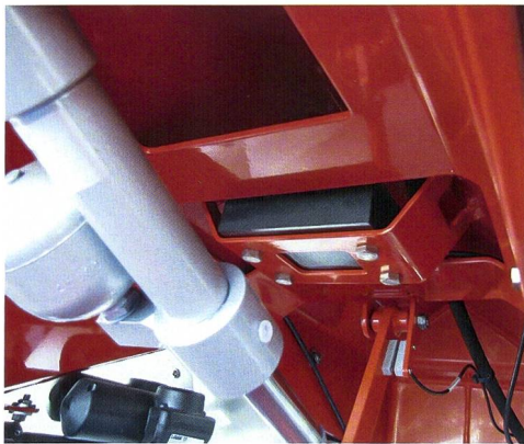
Diese Sensoren unter dem Behälter erfassen die Hangneigung und die durch holprige Fahrt erzeugte Beschleunigung (Fehlerkorrektur der Waage).
