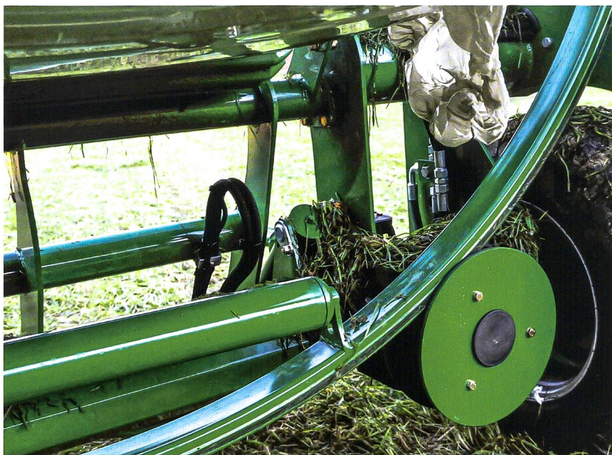
Der Wickelring wird unten von zwei grossen, mit Gummi beschichteten Rollen hydraulisch angetrieben.
