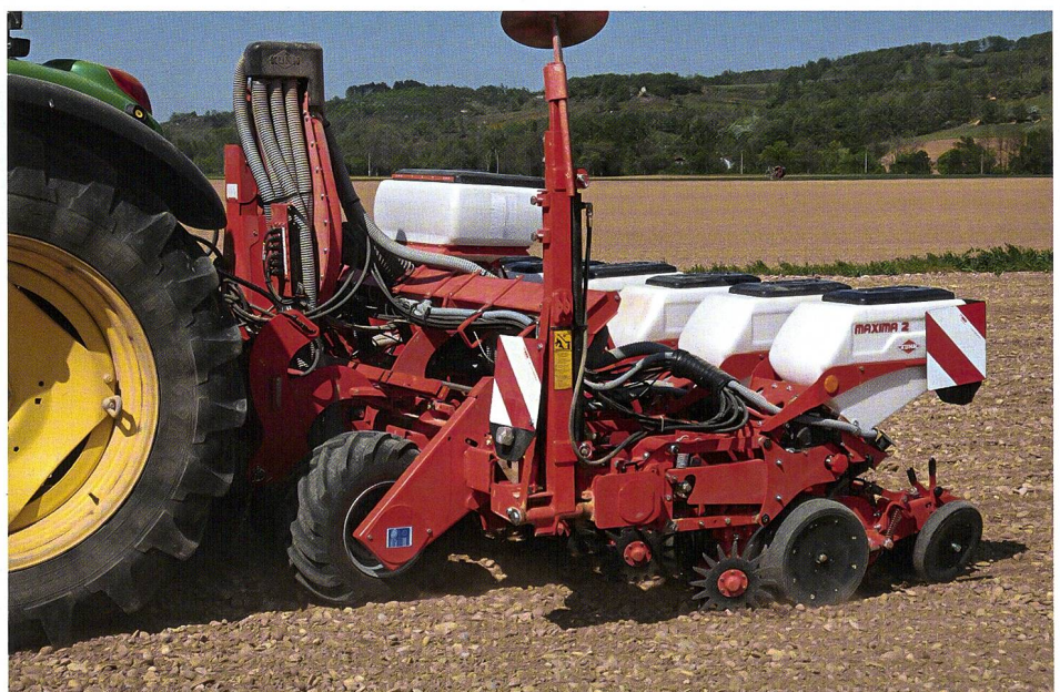
Zur Drehzahlüberwachung der Säwelle werden ebenso Sensoren eingesetzt wie zur Überwachung des Füllstandes im Säkasten.
