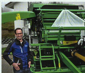
Tobias Brunner erklärt die von ABM entwickelte Folienbindung bei der Ballenpresse «F5500».
