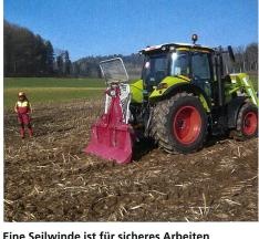
Eine Seilwinde ist für sicheres Arbeiten unerlässlich. Sie muss aber die Sicherheitsanforderungen erfüllen. Der Traktor sollte pro t Zugkraft ca. 12 PS haben, wobei nicht die Stärke, sondern das Gewicht massgebend ist.
