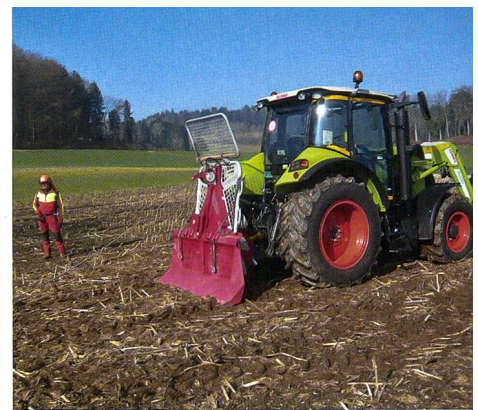
Eine Seilwinde ist für sicheres Arbeiten unerlässlich. Sie muss aber die Sicherheitsanforderungen erfüllen. Der Traktor sollte pro t Zugkraft ca. 12PS haben, wobei nicht die Stärke, sondern das Gewicht massgebend ist.
