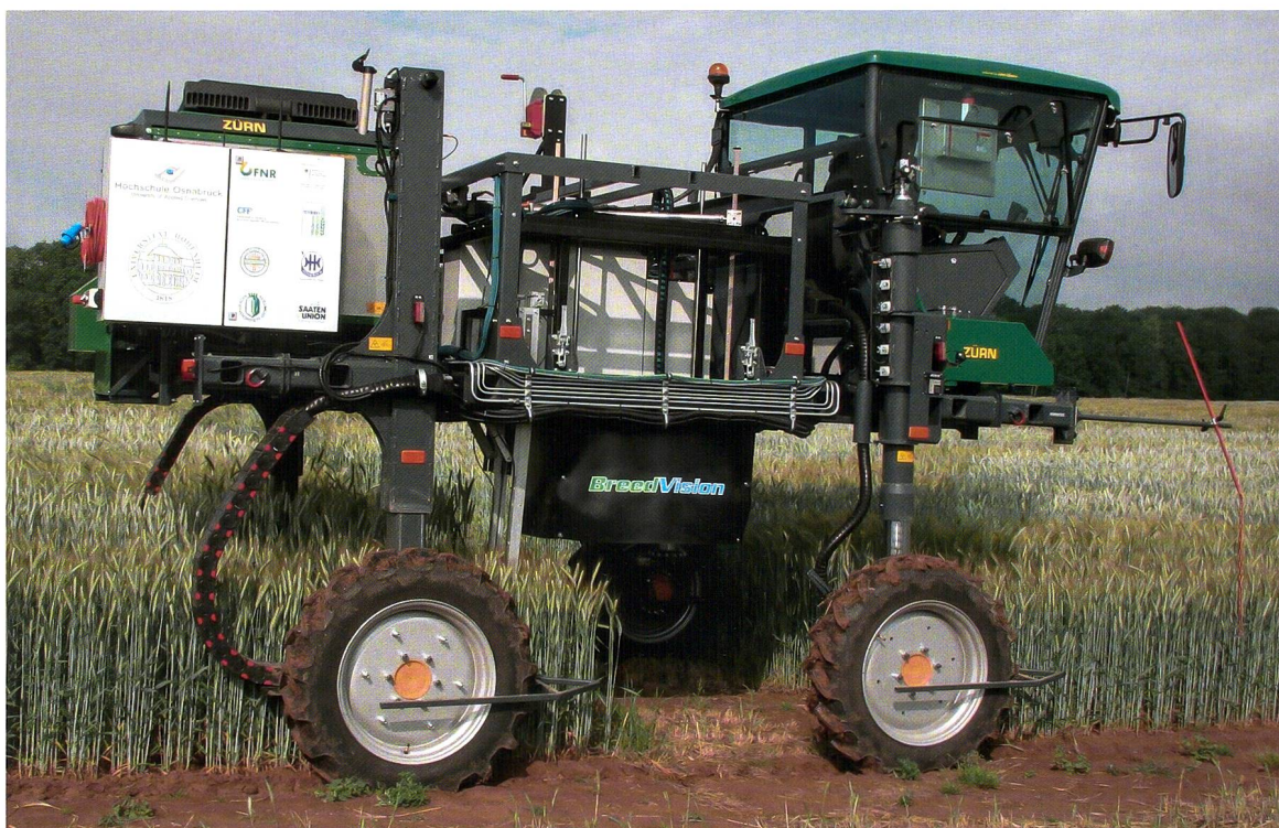
Forschungsprojekt «PredBreed», die fahrbare Phäno- typisierungsplattform zur Messung von Zuchtmerkmalen der Getreidepflanze, ausbaubar zum auto- nomen Feldroboter.
