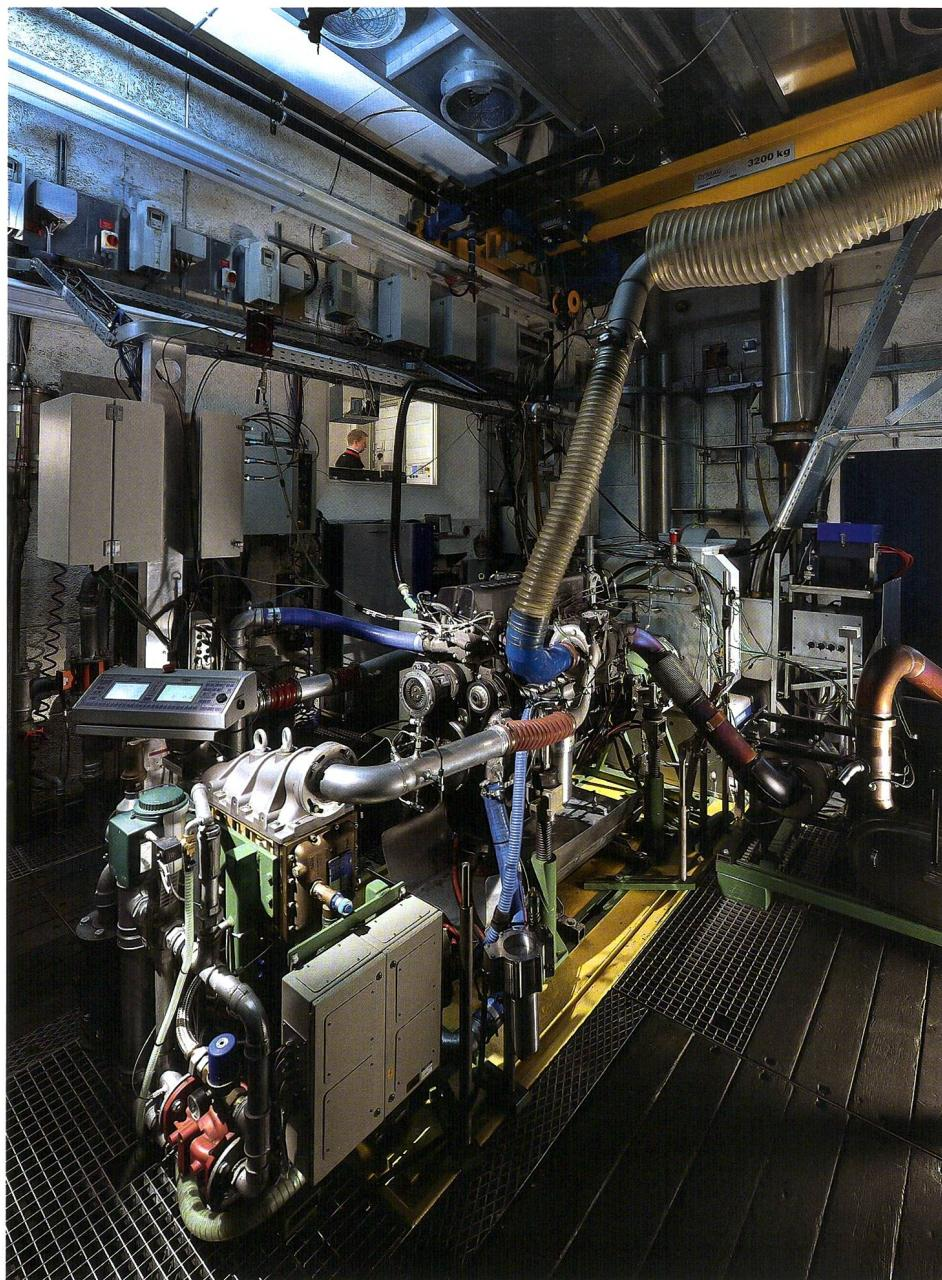
Ingeniösität und technisches Geschick einerseits und modernste Systeme für die Messtechnik andererseits sind Grundvoraussetzungen des technischen Fortschritts. Blick in einen «transienten» Motorenprüfstand. Im Vergleich zu Stationärprüfständen arbeiten transiente Prüfstände mit einem AC-Dynamometer anstelle der Wirbelstrombremse. Außerdem werden statt einzelnen Punkten auf der Leistungskurve gesamte Fahrzyklen nachgebildet. Auch die Kraftstoffmessung ist transientfähig.
