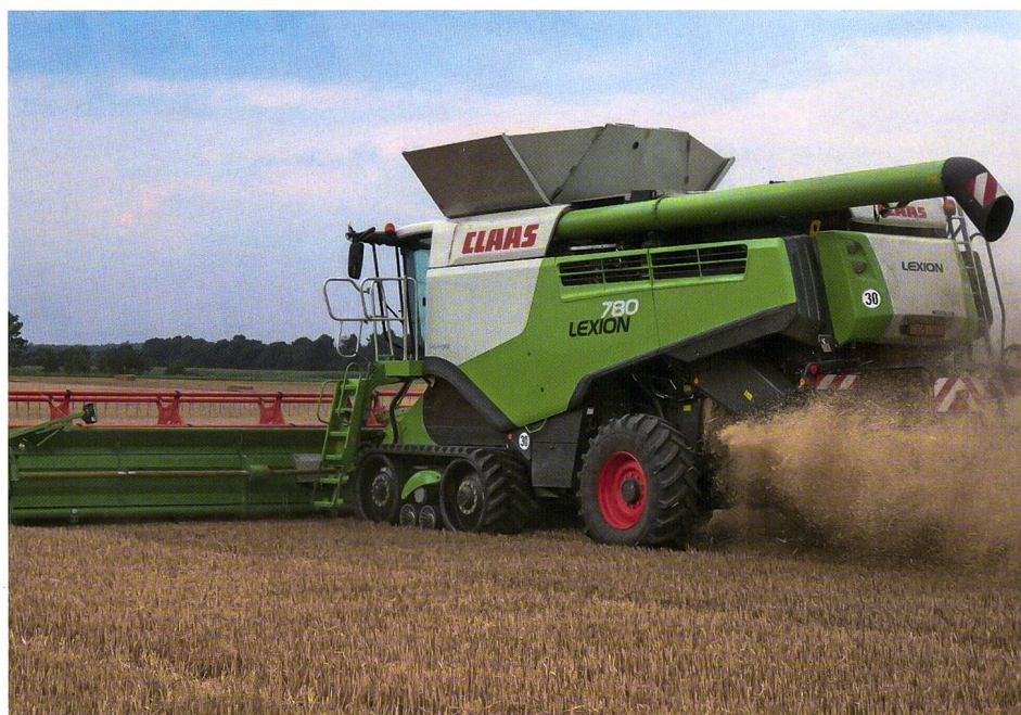
Bei der neuen «Lexion»-Baureihe setzt Claas ein automatisches System zur Vermeidung von Verstopfungen ein.
