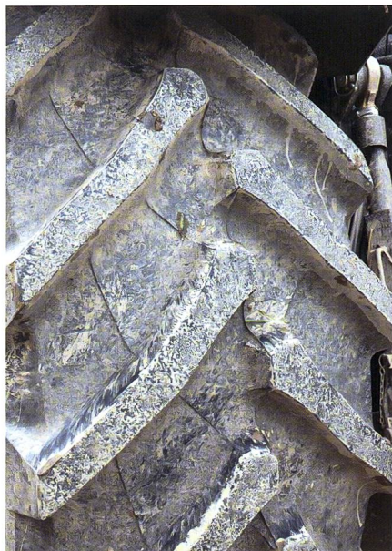
Eine gute Eigenschaft der AS-Reifen ist die gute Selbstreinigung. Bei Industriereifen füllen sich unter feuchten Bedingungen die Stollenzwischenräume relativ rasch mit Erde.
