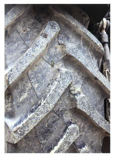
Eine gute Eigenschaft der AS-Reifen ist die gute Selbstreinigung. Bei Industriereifen füllen sich unter feuchten Bedingungen die Stollenzwischenräume relativ rasch mit Erde.
