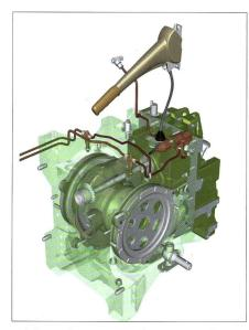
Bei der Serie «6R» von John Deere wirkt der Handbremshebel als Hilfsbremse über ein Servoventil auf die Betriebsbremsen.
