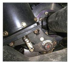
Als Feststell- und Hilfsbremse funktioniert bei JCB eine trockene Scheibenbremse mit Federspeicher auf der Allradwelle.
