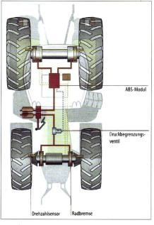
Als Hauptkomponenten kommen beim ABS ein ABS-Modul, Druckbegrenzungsventile und Drehzahlsensoren zum Finsatz.
