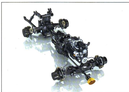
JCB setzt auf dem Schnellläufer «Fastrac» ausschliesslich trockene Teilscheibenbremsen mit zwei Bremssätteln ein.
