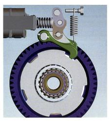
Die Klinkensperre mit elektrischer Entriegelung ersetzt den «eingelegten Gang» und blockiert das Getriebe mit grosser Sicherheit.
