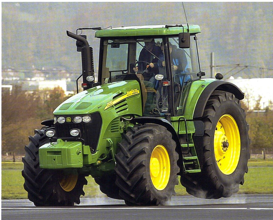
Aufgrund der hohen Trägheitsmomente, stark variierender Gewichtsverteilung und Einsatzgebiete (Steilhang) muss ein Bremssystem am Traktor aber eine höhere Bandbreite an Anforderungen erfüllen. Bilder: zvg
