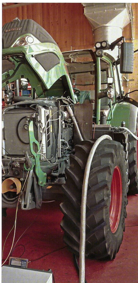
Derzeit werden am TFZ Straubing Tests an einem Fendt «Vario 724» in Abgasstufe-4-Konfiguration durchgeführt.
