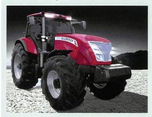
310 PS werden angetrieben von «Beta-Power»- 6-Zylinder-Motoren mit 6,71 Hubraum. Die Aggregate erfüllen die Abgasstufe 4 und verfügen über einen elektronischen Turbolader mit variabler Turbinengeometrie (eVGT). Angepasst an die Anforderungen der Leistungsklasse, sind die Traktoren der Serie «X8» mit dem stufenlosen ZF-Getriebe «Terramatic TMT32» mit vier Fahrbereichen
