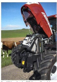
Das Kühlerpaket des FPT-Motors lässt sich für die Reinigung einfach ausklappen.
