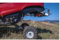
Bis zu 30 % Neigung in Längsrichtung können durch die zwei Hydraulikzylinder ausgeglichen werden.
