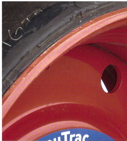
Der «PneuTrac» kann auf konventionellen Felgen montiert werden.
