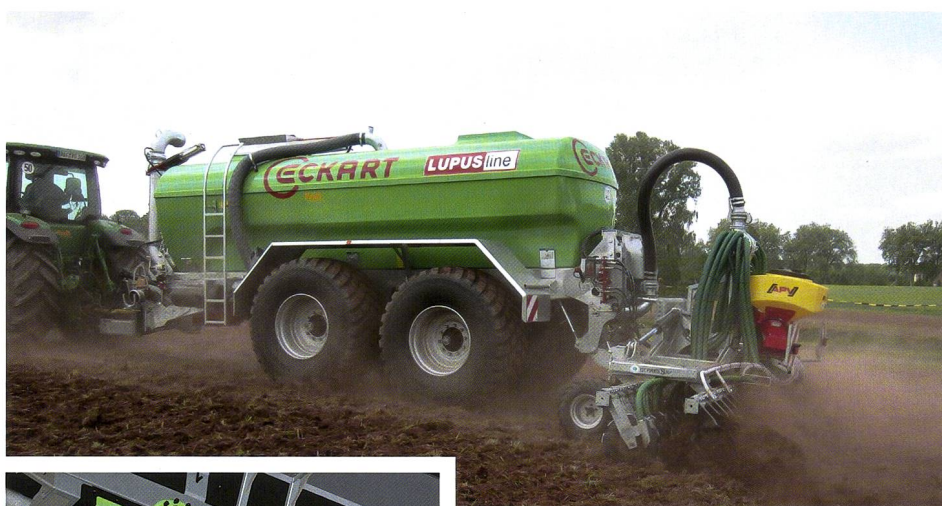
Neues «Lupus+»-Polyesterfass, das dank optimierter Geometrie nicht nur einen tieferen Schwerpunkt erhalten hat, sondern wegen der schmalen Rahmenaufgabe auch einen grösseren Lenkeinschlag.
