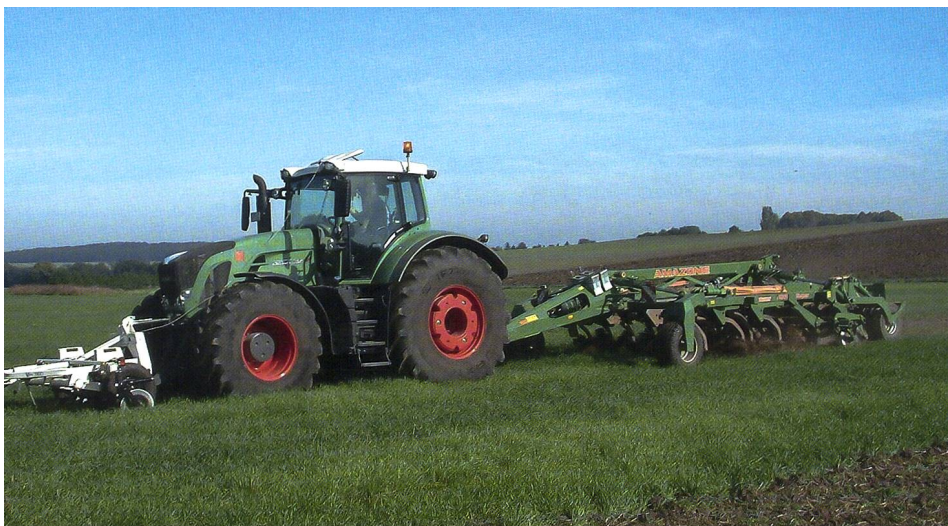
Neue Möglichkeiten: Dieser Grubber wird in Echtzeit durch ein Frontsensordsystem abhängig von der Bodentextur in einer bestimmten Tiefe geführt.
