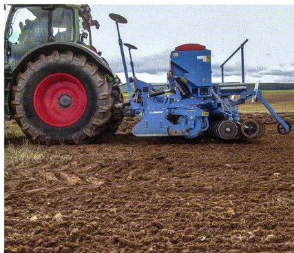
Das Abschalten der Dosierung und das Ausheben der Sämaschine am Vorgewende müssen mit einer bestimmten Verzögerung erfolgen.
