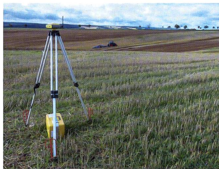
Für viele, punktgenaue Anwendungen unerlässlich: GPS-Positionierungssysteme mit zusätzlicher RTK-Antenne.
