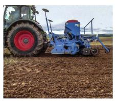
Das Abschalten der Dosierung und das Ausgeben der Sämaschine am Vorgewende müssen mit einer bestimmten Verzögerung erfolgen.
