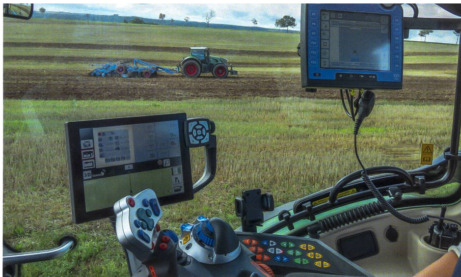
Moderne Steuerung von Landmaschinen: Über den Isobus-fähigen Fendt-Terminal könnte die Steuerung der angebauten Maschinen eigentlich vollständig erfolgen. Zur Unterstützung der Anzeige- und Bedienfunktionen ist in dieser Kabine ein zusätzliches CCI-Terminal installiert. Bilder: Roman Engeler
