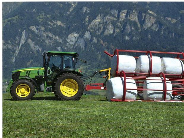
Der irische Hersteller Keltac baut einen Wagen, der beidseitig bis zu vier Rundballen aufnimmt. Er scheitert betreffend Transportbreite an der schweizerischen Strassenverkehrsgesetzgebung (über 255 cm).
