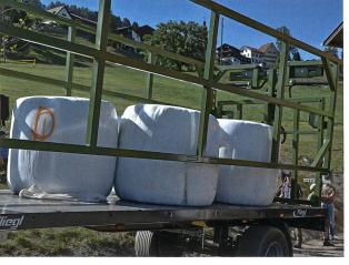
Ein Fliegl-Ballenwagen verriegelt die Seitenwand hydraulisch und sichert damit die Rundballen. Formschlüssig geladen ist keine weitere Sicherung notwendig.
