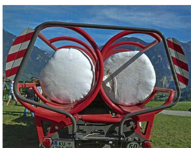
Dank 4-Rad-Lenkung ist der Transporter sehr beweglich zur Ballenaufnahme. Aufgrund des hohen Schwerpunktes kann praktisch nur auf der Strasse gefahren werden, er überschreitet ebenfalls die erlaubte Breite von 255 cm.
