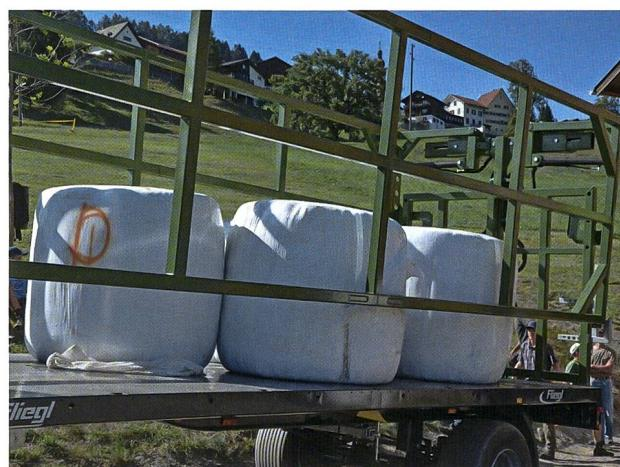
Ein Fliegl-Ballenwagen verriegelt die Seitenwand hydraulisch und sichert damit die Rundballen. Formschlüssig geladen ist keine weitere Sicherung notwendig.
