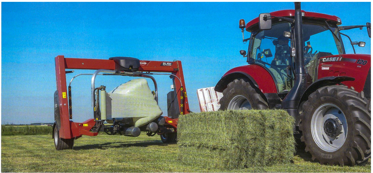
Mit der «Auto Load»-Funktion gewährleistet Kuhn bei seinem Ballenwickler «SW 1414» eine vollautomatische Nonstop-Einstretchung von Quader- und Rundballen, ohne dass der Fahrer in irgendeiner Form eingreifen muss. Bild: Kuhn
