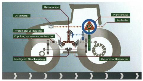
Innovativer Lichtblick beim Traktor: das Allradmanagement beim Fendt-«Vario 1000», das den Wirkungsgrad des gesamten stufenlosen Antriebs massiv verbessern soll. Bild: zvg
