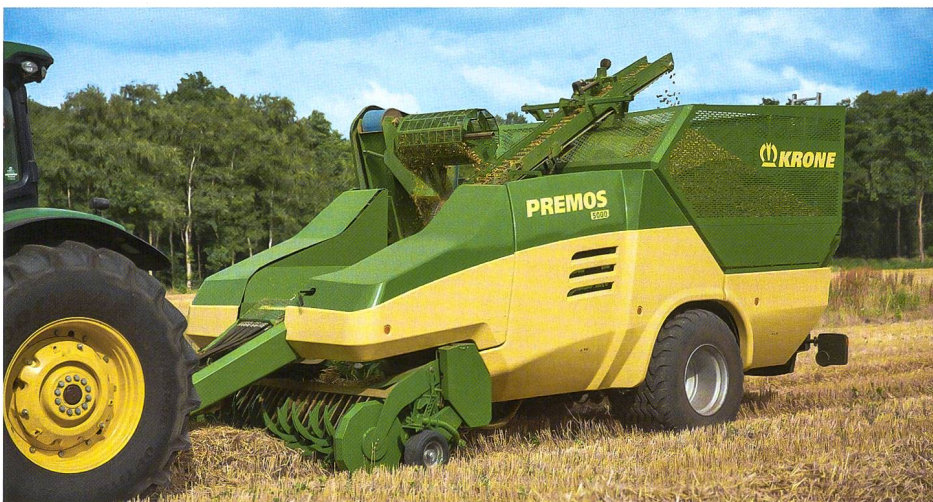
Eine echte Neuheit in Stahl und Eisen stellt die Presse «Premos 5000» dar, mit der auf dem Feld das Stroh in Pellets gepresst werden kann. Bild: Krone
