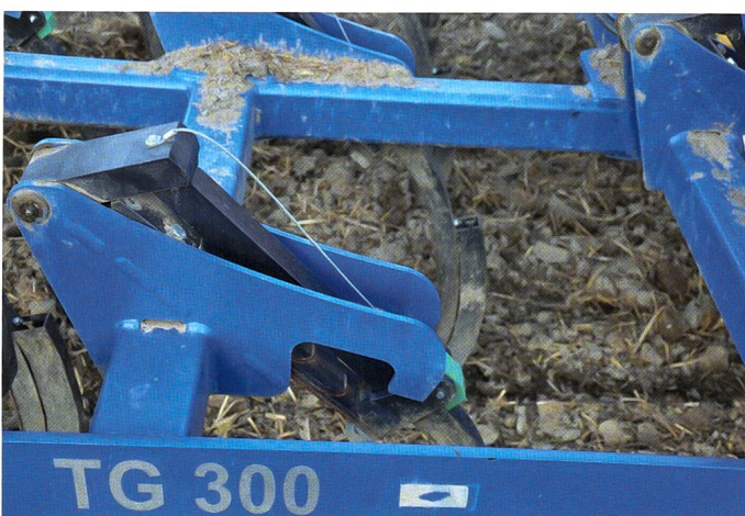
Die Hardox-Zinken sind seitlich geführt und können nur nach hinten ausweichen. Eine Abscherschraube im (grünen) Gleitklotz sichert den Zinken vor Bruch.
