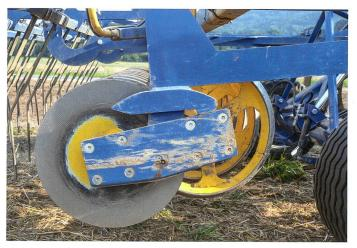
Der Grubber wird im Heck auf zwei Pendel-Packerwalzen abgestützt. Auf Wunsch gibt es ein Scheibenrad zur Stabilisierung des Grubbers am Hang.
