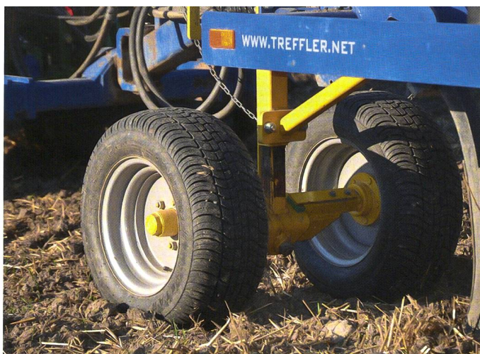
Ein Rezept für die zuverlässige Arbeitstiefe, verbunden mit guter Boden Anpassung, hat Treffler mit den Pendelstützradpaaren gefunden.
