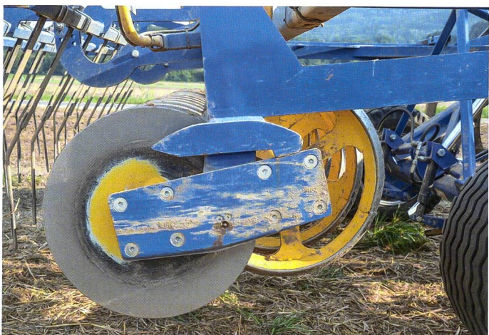
Der Grubber wird im Heck auf zwei Pendel-Packerwalzen abgestützt. Auf Wunsch gibt es ein Scheibenrad zur Stabilisierung des Grubbers am Hang.
