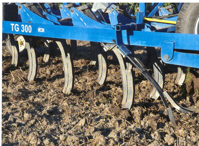
Der Strichabstand beträgt 17,6 cm. Hinter den Zinken und vor dem Doppelpacker ebnen Blattfederzustreicher den Boden ein.
