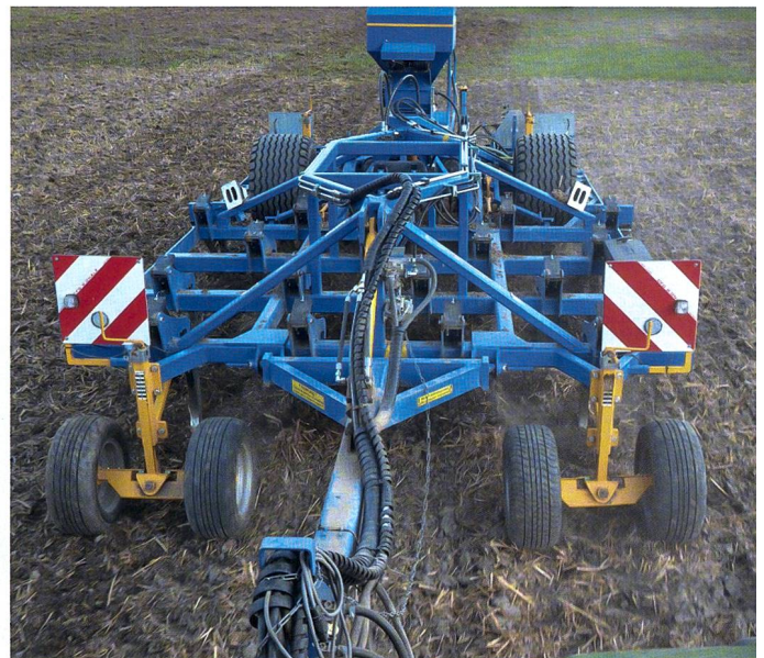
Ohne «ach» auch flach – der Präzisionsgrubber von Treffler eignet sich besonders für die flache Bodenbearbeitung mit ganzflächigem Schnitt von Unkräutern.
