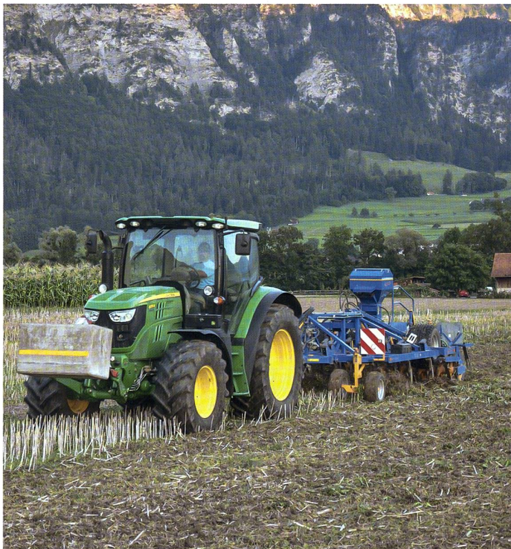
Ohne «ach» auch flach – der Präzisionsgrubber von Treffler eignet sich besonders für die flache Bodenbearbeitung mit ganzflächigem Schnitt von Unkräutern.
