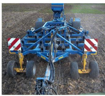
Ohne «ach» auch flach – der Präzisionsgrubber von Treffler eignet sich besonders für die flache Bodenbearbeitung mit ganzflächigem Schnitt von Unkräutern.
