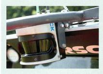
ein Flächenmodell erstellt, welches das Geländerelief mit Lücken, Fahrgassen oder Hindernissen im Bestand oder im Gelände wiedergibt. So können über den Bestand herausragende Hindernisse erkannt werden, und das Gestänge wird entweder über das Hindernis angehoben oder es wird ein Warnhinweis ausgegeben, wenn das Hindernis (z. B. Strommasten) umfahren werden muss. Für diese Innovation erhielt Horsch von der Neuheiten-Kommission der Agritechnica eine silberne Auszeichnung.
