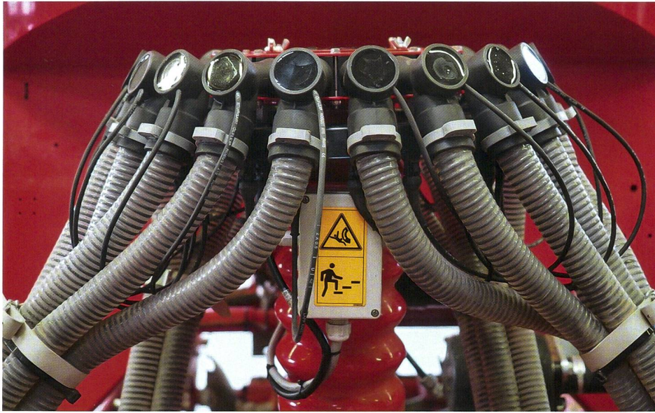
Kein Abdrehen mehr mit «SeedControl», womit man die einzelnen Körner zählen kann und die Aussaat mit Körnern pro Quadratmeter bestimmt.
