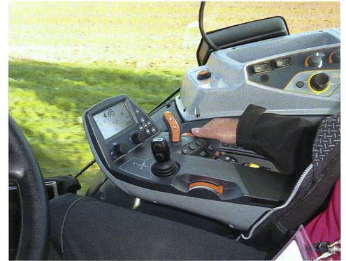
Die Armlehne bei den Modellen «Versu» und «Direct» mit Bedienung der elektrischen Steuergeräte.
