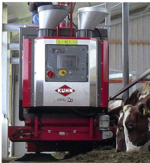
Der «Feed Robot» von Kuhn mischt dank schichtweiser Befüllung beim Austragen die verschiedenen Komponenten.
