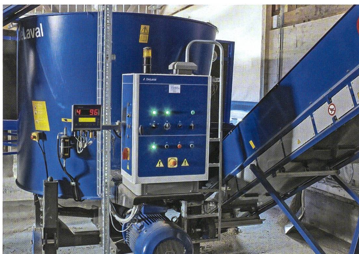
Das Herzstück des «Optimat» von Delaval ist ein Stationärmixer. Der automatische Verteilwagen (rechts) kann auch später installiert werden.
