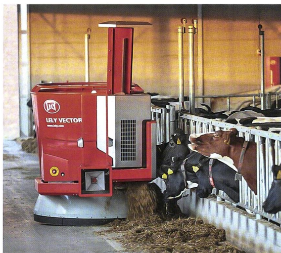
Der «Vector» von Lely kann erkennen, wie viel Futter noch übrig ist. Die übersichtliche Befüllung mit Greifer benötigt wenig Platz.
