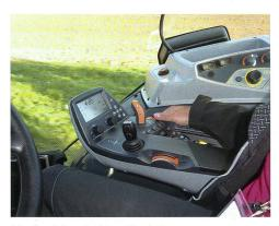
Die Armlehne bei den Modellen «Versu» und «Direct» mit Bedienung der elektrischen Steuergeräte.
