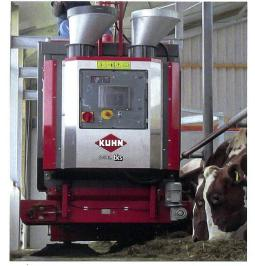
Der «Feed Robot» von Kuhn mischt dank schichtweiser Befüllung beim Austragen die verschiedenen Komponenten.
