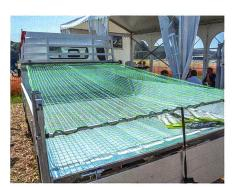
Die Ladung muss auf Lieferwagen stets gesichert sein. Bei diesem System wird das Netz automatisch aufgerollt, muss aber zusätzlich fixiert sein.
