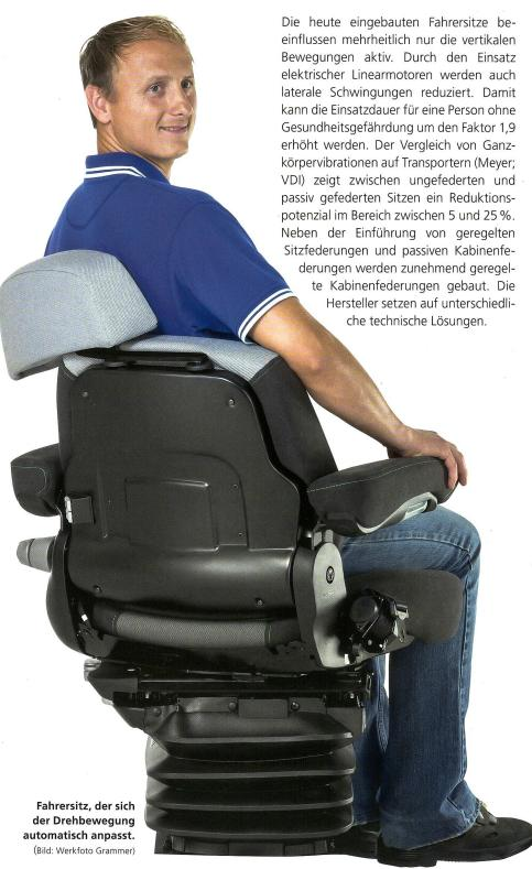
Claas realisiert mit dem «Z-Activ» mittels magnetorheologischer Flüssigkeit die Dämpfungsveränderung; die Dämpfung bzw. die Viskosität der Flüssigkeit wird durch ein Magnetfeld beeinflusst.
