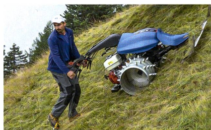
Mit Steigeisen hat auch der Maschinenführer gleiche Bedingungen wie sein Motormäher.
