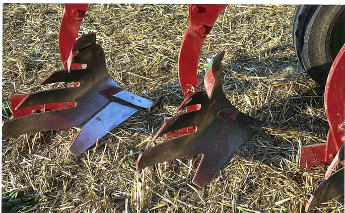
Richtig verwendet, arbeitet der Schälplug sehr flach.
