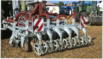
Gülle Strip-Till-Anbaugerät am Gülle-Selbstfahrer.
