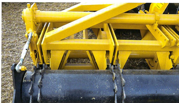
Ein nur 18cm breiter Frässtreifen bei gleicher Traktorleistung verspricht mehr Flächenleistung und damit höhere Energieeffizienz.
