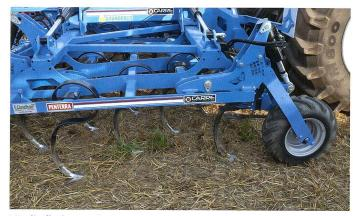
Für die flache Bearbeitung der Flachgrubber von Carré.
