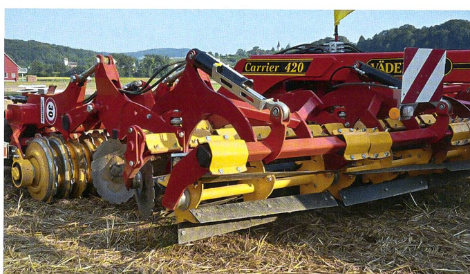
Im Bereich der flachen Bodenbearbeitung arbeitet diese Scheibenegge mit einer vorlaufenden Messerwalze.
