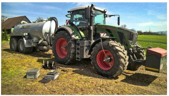
Das Versuchsgespann: ein Fendt 828 und ein 12000-l-Tandem-Güllefass von Bauer, hier bei einer Testfahrt zur Messung des Bodendrucks. (Bilder: Matthias Stettler)
