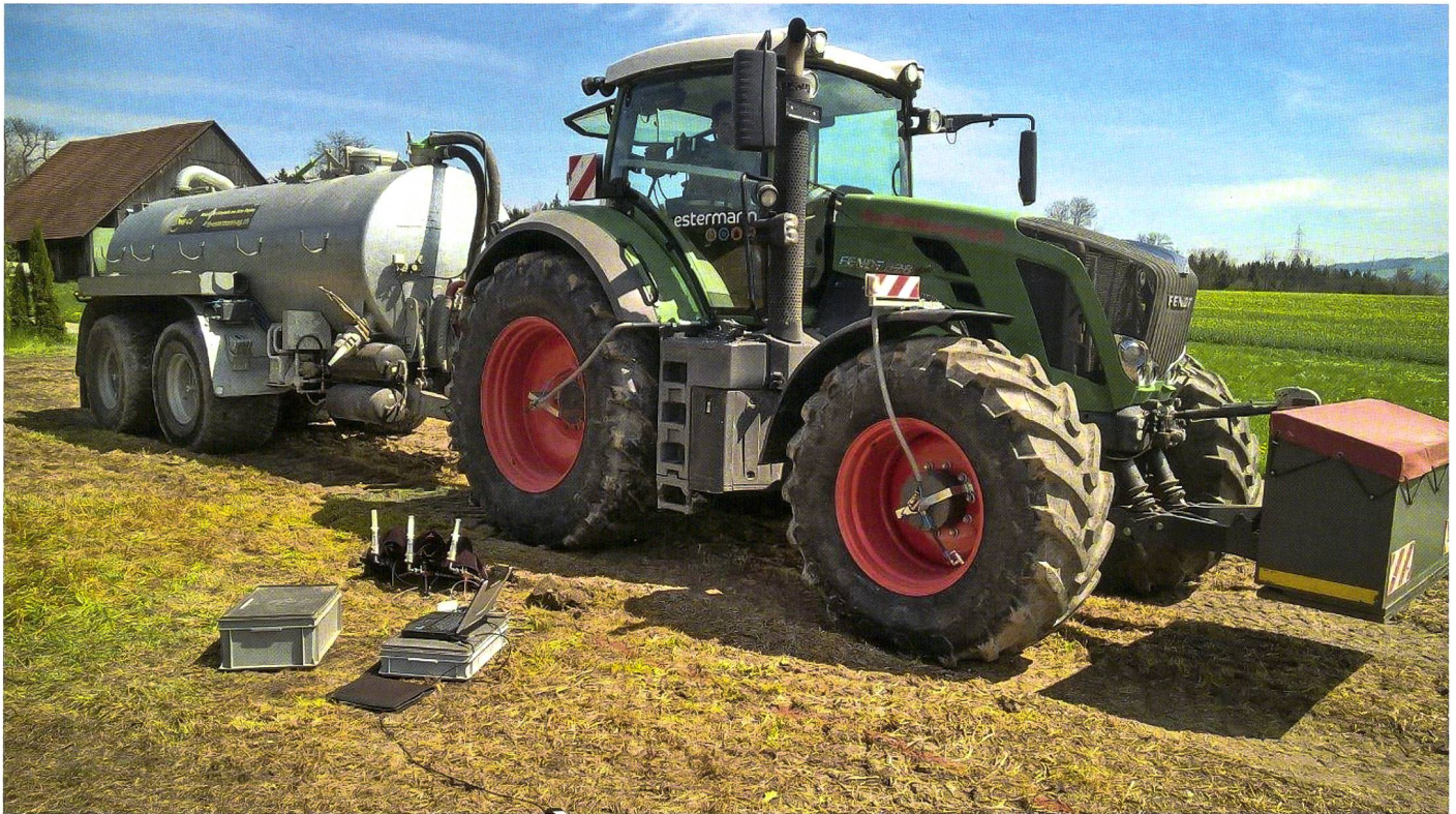
Das Versuchsgespann: ein Fendt 828 und ein 12000-l-Tandem-Güllefass von Bauer, hier bei einer Testfahrt zur Messung des Bodendrucks.
