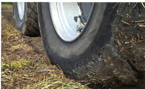
Tandembereifung am Bauer-Güllefass mit durch die Achsen geführter 2-Leiter-Reifendruckregelanlage.
