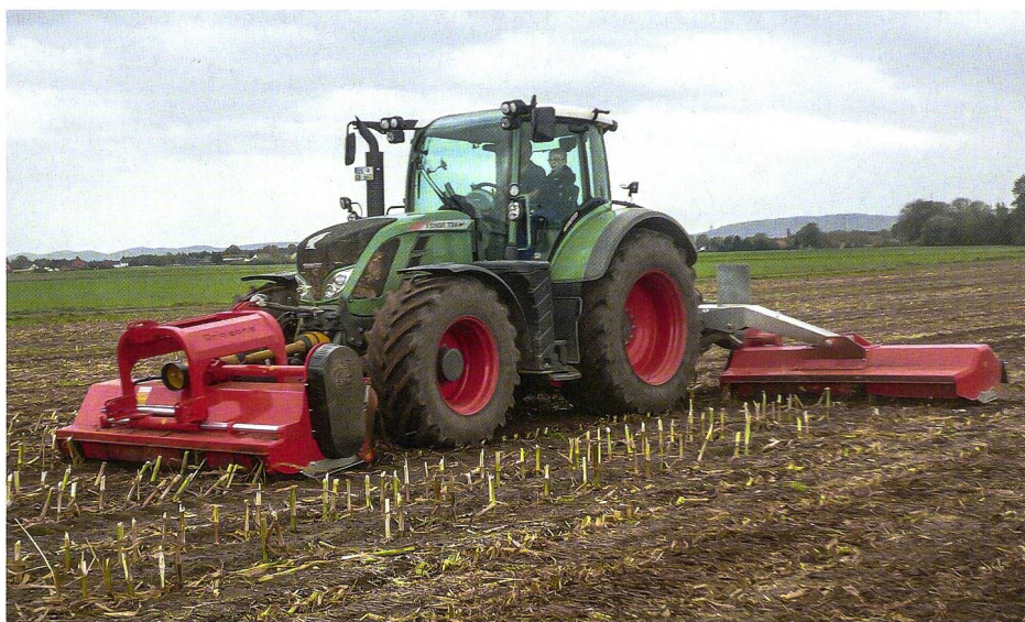
Der Frontanbau ist eine gute Lösung, da nicht noch zusätzlich Stoppeln und Stroh niedergefahren und in den Boden gedrückt werden. (Bilder: Ruedi Hunger)
