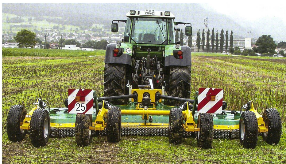
Y-Schlegel mit Räumklinge (r.) sind eine interessante Alternative zum Hammerschlegel.
