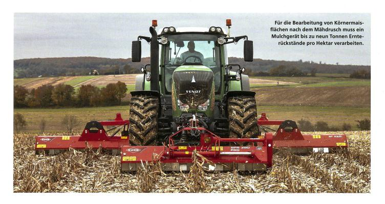
Eine intensive Zerkleinerung der Ernterückstände von Silo-, CCM- und Körnermais wird erreicht, wenn das Mulchgerät gleichmässig tief geführt wird, ohne aber den Boden durchgehend «zu bearbeiten». Die Arbeit eines Mulchers wird wie folgt bonitiert:
