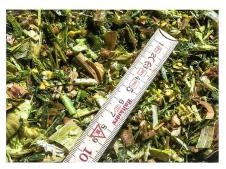
Eindrückliches Resultat beim ersten Testeinsatz: Die Körner sind zu so kleinen Stücken zermahlen, dass man diese erst bei genauem Hinsehen erkennt.
