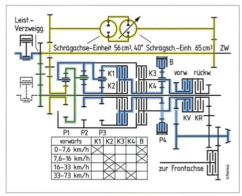
Abbildung 1: Leistungsflüsse in Fahrbereich 1, vorwärts.
