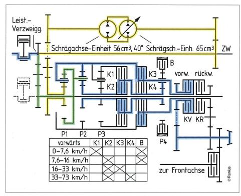
Abbildung 2: Leistungsflüsse in Fahrbereich 3, vorwärts.
