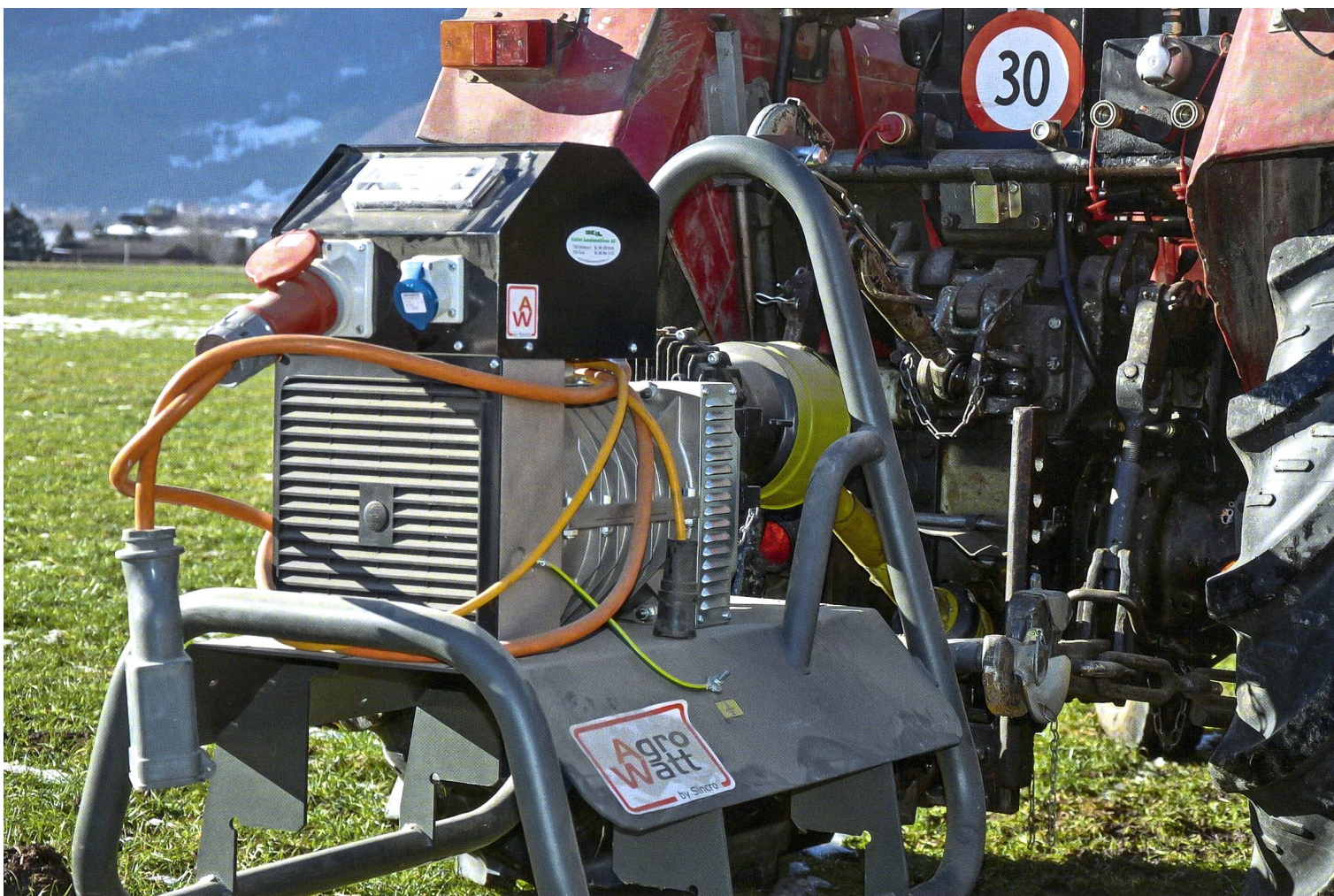
Generatoren für den 3-Punkt-Anbau sind leistungsfähig und benötigen traktorseitig genügend Antriebsreserven. (Bilder: Ruedi Hunger)
