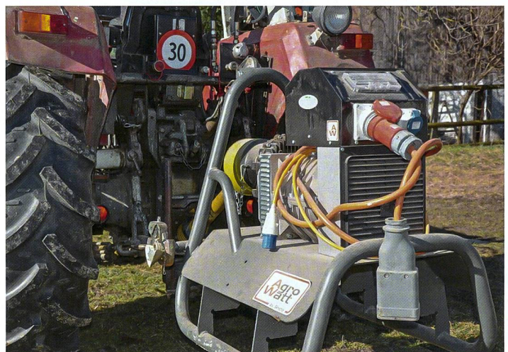
Kabel und Stecker/Steckdose müssen den geltenden Vorschriften entsprechen. Alte Stecker sind auszuwechseln.
