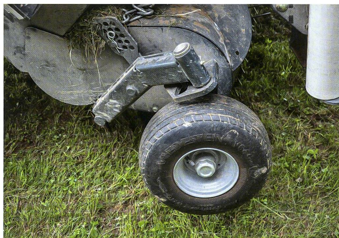
Auf Wunsch wird die Pickup mit nachlaufenden Tasträdern ausgerüstet.
