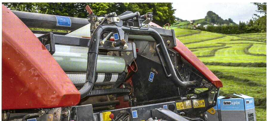
...sie schwenken zur Bindung in die Horizontale und formen mit Überlappung eine breite Folienlage über den Ballen. (Bilder: Ruedi Hunger)
