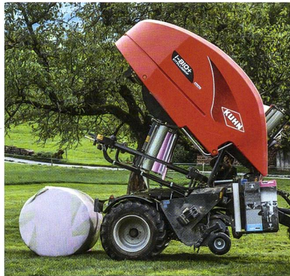
Das «IntelliWrap™»-Wickelsystem verfügt über zwei Vorstrecke, die mit 50 U/min um den Ballen rotieren.
