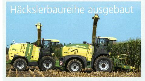
Krone kommt mit drei neuen Feldhäckslern des Typs «Big X» auf den Markt und komplettiert so die Produktpalette in den beiden Einzugskanalbreiten 800 und 630 mm mit einem 753 PS respektive mit einem 530 und 626 PS starken Modell.
