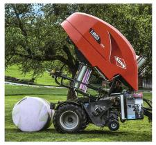
Das «IntelliWrapTM»-Wickelsystem verfügt über zwei Vorstrecker, die mit 50 U/min um den Ballen rotieren.
