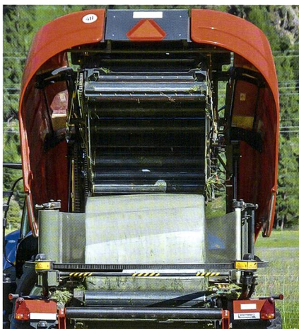
Nach der Folienbindung wird bei geöffneter Presskammer der Rundballen gewickelt.
