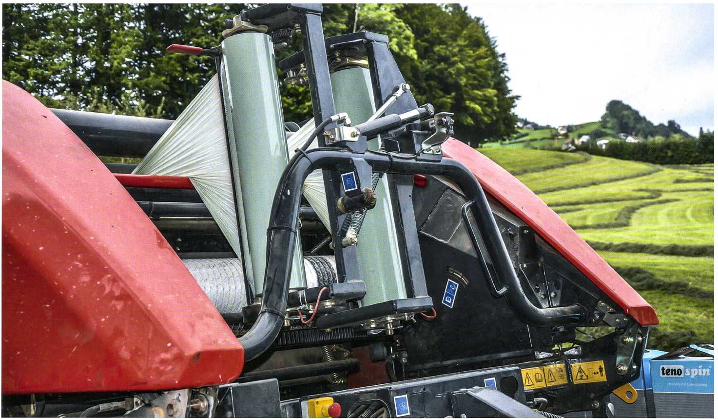
Alleinstellungsmerkmal sind die vor dem Bindeprozess senkrecht stehenden Folienrollen...
