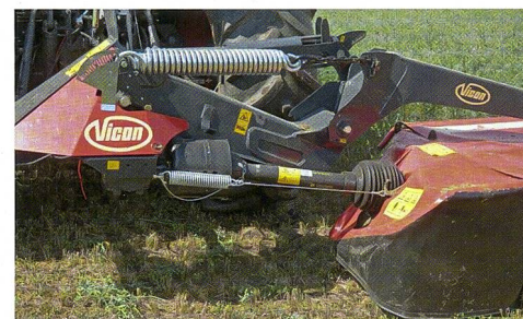
Für die Heckmähwerke hat Kverneland ein neues Konzept zur Entlastung, basierend auf einer Kombination von Federn und Hydraulikzylindern, entwickelt.
