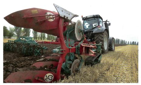
Mit der neu entwickelten Pflugbaureihe «2500» zielt Kverneland auf das wachsende Marktsegment der 5- und 6-scharigen Pflüge. Die Raupe dient bei diesem Modell als bodenschonende Alternative zum konventionellen Stützrad. (Bilder: Roman Engeler)
