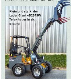
Einsatzmöglichkeiten. Erstaunen weckt der kleine Lader «D254SW Tele» durch seine Hubkräfte und Kipplasten von bis zu zwei Dritteln des Eigengewichts, und dies bei guter Standsicherheit. Bemerkenswert ist der neue Teleskophubarm:
