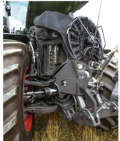
Die leicht nach oben geneigte Lüfteranordnung und eine abgerundete Lüfterhutze sichern eine breite Luftanströmung und reduzieren das Ansaugen von Ernterückständen.
