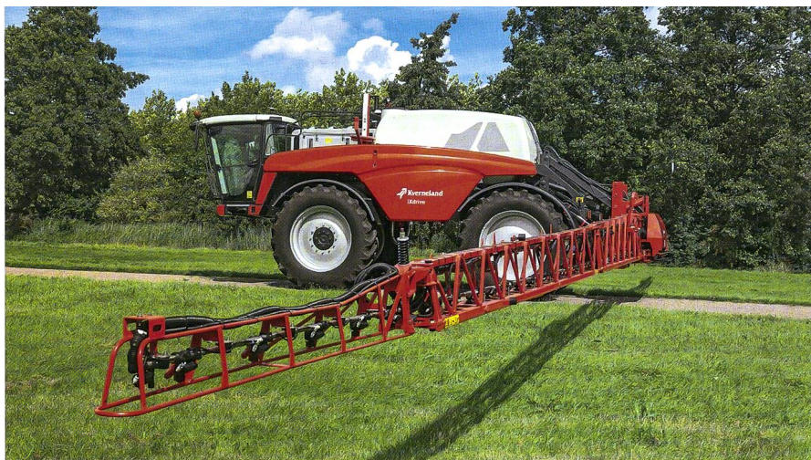
Die selbst fahrende Feldspritze «iXdrive» wird es mit einem 4000 oder 5000l fassenden Tank sowie mit Gestängebreiten von 24 bis 40m geben.
