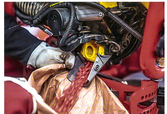
Die Säckästen der «Tempo V» können sehr einfach und schnell über die gelbe Klappe entleert werden.
