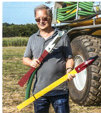
Sebastian Zunhammer senior präsentiert den neuen Gleitschuhverteiler Glide-Fix; er ist wesentlich leichter als bisherige Modelle und erreicht einen Bodenandruck von bis zu 6 kg.
