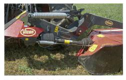
Für die Heckmähwerke hat Kverneland ein neues Konzept zur Entlastung, basierend auf einer Kombination von Federn und Hydraulikzylindern, entwickelt.
