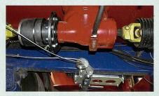
Die Soft-Start-Kupplung von Siloking. (Bild: zvg)
