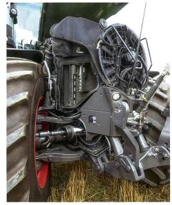
Die leicht nach oben geneigte Lüfteranordnung und eine abgerundete Lüfterhutze sichern eine breite Luftanströmung und reduzieren das Ansaugen von Ernterückständen.
