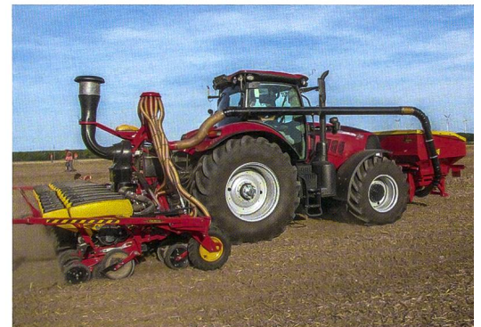
Bei der Dreipunkmaschine «Tempo V» wird weit oben möglichst staubfreie Luft angesaugt.
