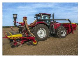
Bei der Dreipunktmaschine «Tempo V» wird weit oben möglichst staubfreie Luft angesaugt.
