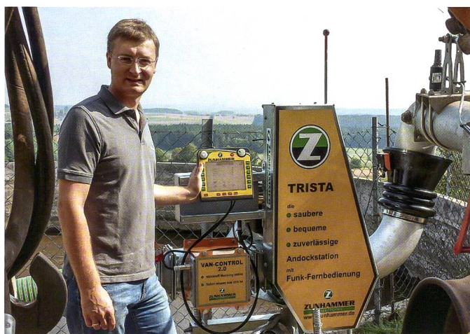
Sebastian Zunhammer junior präsentiert die neue Kompakt-Generation «Van-Control 2.0». In Kombination mit Isobus und Precision Farming wird die Gülleausbringung nährstoffbasiert möglich, nach Gesamt-N, Ammonium-N, Phosphat und Kali. (Bilder: Ueli Zweifel)
