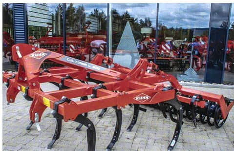
Der Universalgrubber «Cultimer L 300» mit Steinsicherung.
