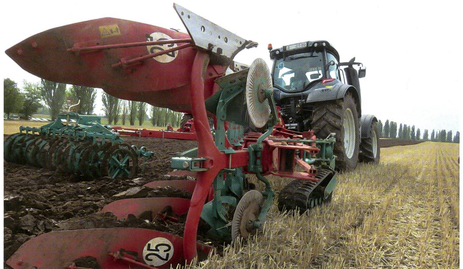
Mit der neu entwickelten Pflugbaureihe «2500» zielt Kverneland auf das wachsende Marktsegment der 5- und 6-scharigen Pflüge. Die Raupe dient bei diesem Modell als bodenschonende Alternative zum konventionellen Stützrad. (Bilder: Roman Engeler)
