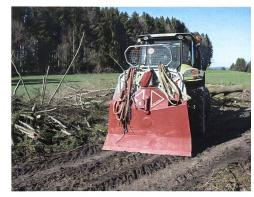
Getriebeseilwinde mit konstanter Zugkraft und kontrolliertem Seilausstoss am Beispiel Tajfun.
