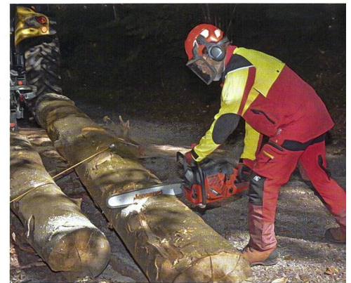
In idealer Weise verbindet die moderne Schnittschutzhose «Defender Pro» Sicherheit, Strapazierfähigkeit und Bewegungsfreiheit.
