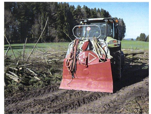
Getriebeseilwinde mit konstanter Zugkraft und kontrolliertem Seilausstoss am Beispiel Talfun.
