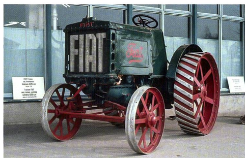
Der erste Fiat-Traktor von 1919 mit Petrolmotor von 6235 cm 3 .
