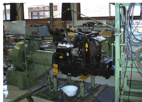
Auf dem Motorenprüfstand in Tänikon würden auch zukünftig nichtlimitierte Schadstoffe wie die Partikelanzahl PN gemessen.
