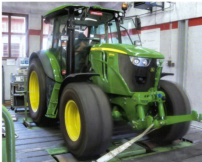
Älterer Rollenprüfstand in Tänikon, der durch einen Radnabenprüfstand ersetzt werden soll.
