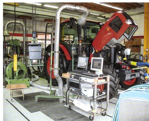
Der Zapfwellenprüfstand in Tänikon liefert umfassende Leistungs- und Verbrauchsdaten.
