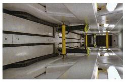
Niederzieheinrichtung am Rollenprüfstand.
