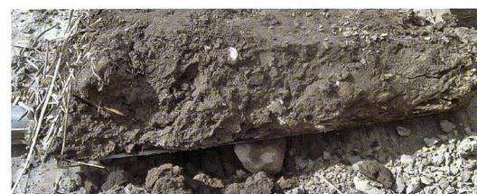
Die Spatenprobe zeigt oberflächliche Verdichtungen klar auf. (Bild: Adrian v. Niederhäusern)
