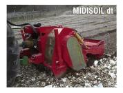
Beim Fräsen von Stein und Boden im ersten Gang verdoppelt sich das Drehmoment, und der Verschleiss wird reduziert.
