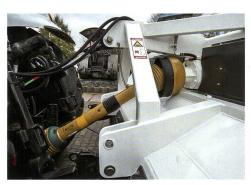
Eine ungünstige Anordnung der Gelenkwelle (Gelenkart und Beugewinkel) kann eine ungleichförmige Drehbewegung im Antriebsstrang verursachen und ihn beschädigen. Die passende Überlastkupplung schützt nicht nur die Maschine, sondern auch das Getriebe des Traktors.
