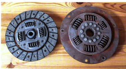
Sowohl herkömmliche Fahrkupplungen (links PW) als auch die nicht lösbaren Kupplungen (rechts Traktor ohne Fahrkupplung) haben federnde Naben, welche die grössten Drehmomentspitzen beim Anfahren und Gangwechsel dämpfen.
