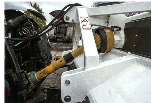
Eine ungünstige Anordnung der Gelenkwelle (Gelenkart und Beugewinkel) kann eine ungleichförmige Drehbewegung im Antriebsstrang verursachen und ihn beschädigen. Die passende Überlastkupplung schützt nicht nur die Maschine, sondern auch das Getriebe des Traktors.
