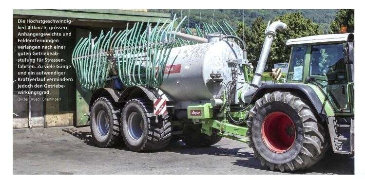
bereich angenommene Drehmomentanstieg ergibt eine durchgehend verfügbare Leistung von 90 % der Nennleistung. Das Diagramm beweist, dass sich unter diesen Voraussetzungen die maximalen Zugkräfte zwischen den benachbarten Gängen überlagern und daher über den ganzen Fahrbereich dieser vier Gänge die Zugleistung nicht eingeschränkt wird. Ein Stufensprung unter 1,2 hätte in diesem Fall keinen technischen Mehrnutzen.
