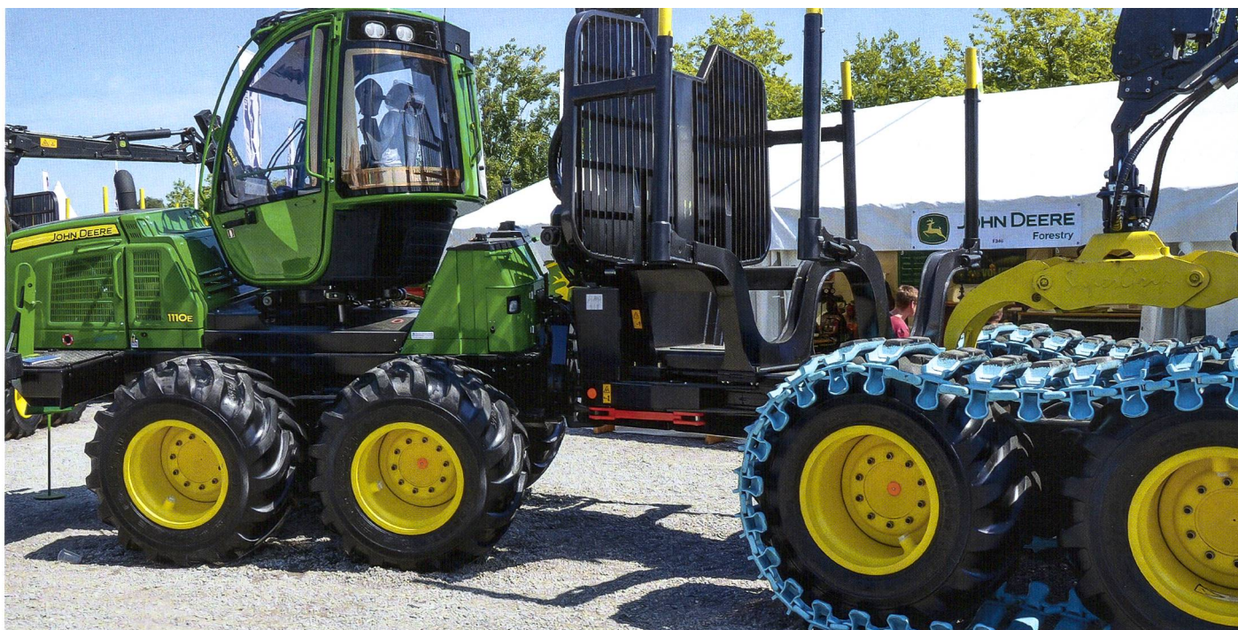
Bogiebänder, erst als Traktionshilfe gedacht, später zu Bodenschonung angepriesen und heute kontrovers diskutiert. Breite Reifen in Verbindung mit abgesenktem Luftdruck erreichen einen vergleichbaren Effekt. (Bild: Ruedi Hunger)
