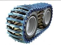
Aggressive Bogiebänder sollten nur in extremen Hanglagen (>20 %) und aufgrund des Fäulerisikos (Wurzelverletzungen) nur in älteren Beständen eingesetzt werden.
