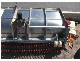
Die Pickup wird mit einem einfachen mechanischen Antrieb angetrieben. Die Doppelrollen können mittels Steckbolzen einfach verstellt werden.
