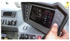
Zur Unterstützung des Fahrers hat Reform ein Bedienerleitsystem entwickelt. Für insgesamt sieben verschiedene Einsatzarten werden dem Fahrer am Terminal die optimalen Einstellungen vorgeschlagen.
