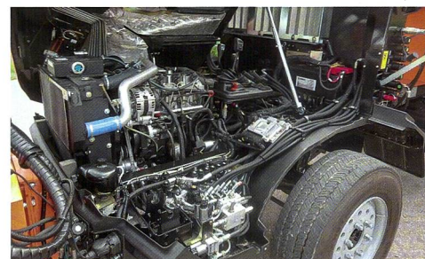
Dank der kippbaren Kabine ist der Zugang bei Wartungsarbeiten vereinfacht.
