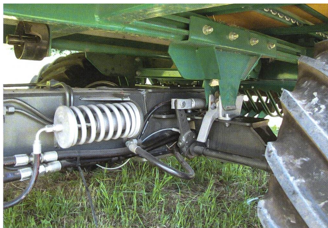
Neben den Kuppelpunkten sind auf diesem Bild der Betriebsbremszylinder und die Federspeicherbremse (links) zu sehen.
