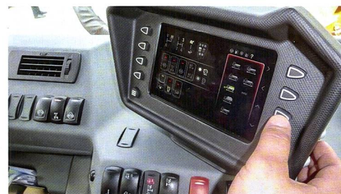
Zur Unterstützung des Fahrers hat Reform ein Bedienerleitsystem entwickelt. Für insgesamt sieben verschiedene Einsatzarten werden dem Fahrer am Terminal die optimalen Einstellungen vorgeschlagen.
