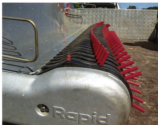
Die wellenförmige Zinkenordnung soll das Abgleiten des Futters begünstigen. In dieser Ansicht gut sichtbar ist die spezielle Form der schwarzen Abstreifer.
