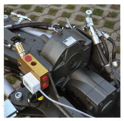
Vorne im Chassis ist die Pumpeneinheit mit Durchtrieb für Aufbaugeräte integriert.
