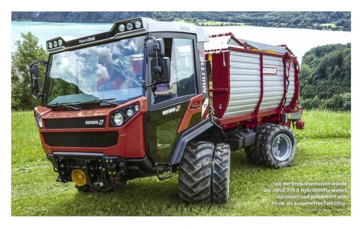
Die Hersteller von Transportern taten sich bisher etwas schwer mit der Entwicklung und dem Einbau von stufenlosen Getrieben in ihre Fahrzeuge. Reine Hydrostatlösungen (wie in Hanggeräteträgern oder Zweiachsmähern bekannt) sind wegen des beeinträchtigten Wirkungsgrades bei Transport- oder Zugarbeiten nicht geeignet. Zudem standen die knappen Bauräume und die hohen Entwicklungskosten bei den begrenzten Stückzahlen bisher der Entwicklung stets etwas im Wege.
