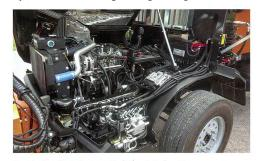
Dank der kippbaren Kabine ist der Zugang bei Wartungsarbeiten vereinfacht.
