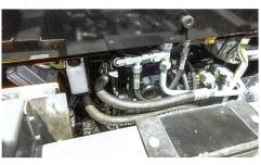
Die hydrostatischen Einheiten sind beim Getriebe angeflanscht: links der Hydromotor und rechts die Ölpumpe.
