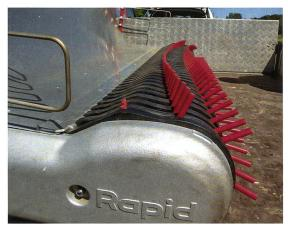
Die wellenförmige Zinkenanordnung soll das Abgleiten des Futters begünstigen. In dieser Ansicht gut sichtbar ist die spezielle Form der schwarzen Abstreifer.
