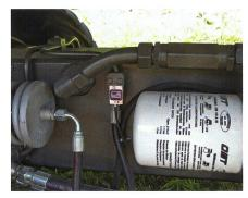
Der Neigungssensor (Mitte) und viele Komponenten wie der Filter werden bei den Serienmaschinen noch ins Innere des Chassis verlegt.
