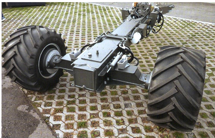
Das schlanke Zentralrohrchassis mit integriertem Öltank ermöglicht ein tiefes Eigengewicht und eine hohe Flexibilität mit Aufbauten.
