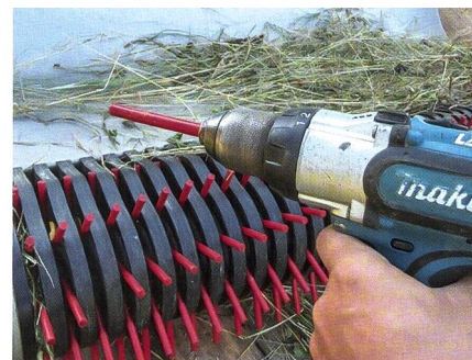
Die weichen Zinken ohne geschnittenes Gewinde können mit dem Schrauber einfach ins harte Gewinde der Walze geschraubt werden.
