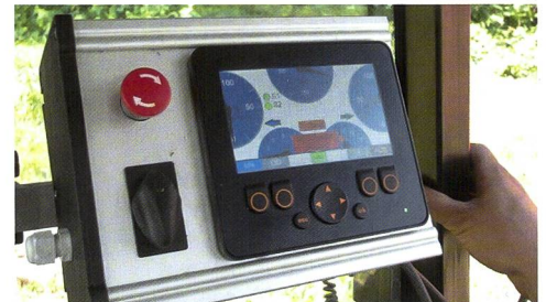
Das Display bietet mit fünf digitalen «Zeigern» und Statusleuchten eine sehr gute Übersicht über den Betriebszustand.
