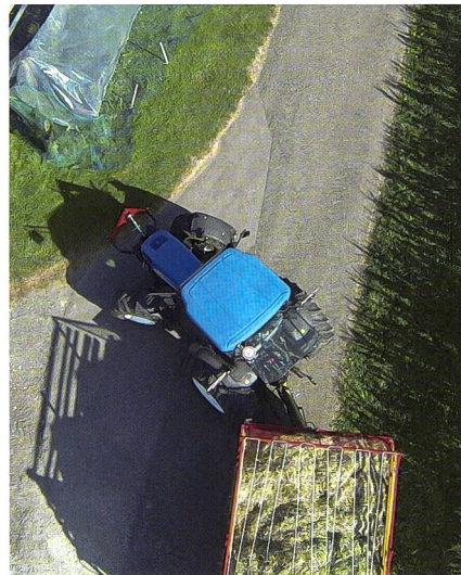
Die Lenkdeichsel bietet einen engen Einschlagwinkel ohne Räderberührung.
