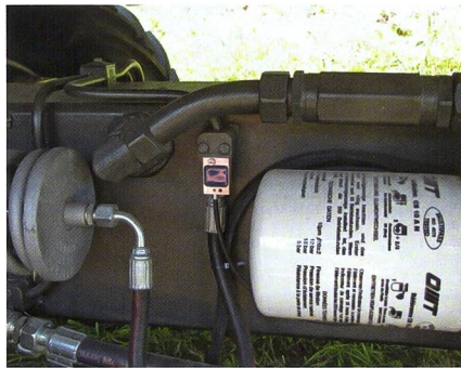
Der Neigungssensor (Mitte) und viele Komponenten wie der Filter werden bei den Serienmaschinen noch ins Innere des Chassis verlegt.
