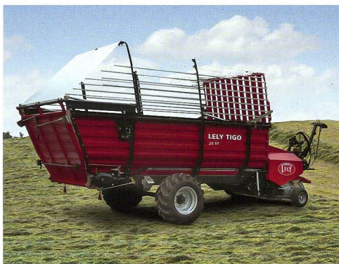
Der vorhandene Traktor und die Hangneigung bestimmen die Ladewagengrösse, weit mehr als beim Hochlader. (Bild: Lely)
