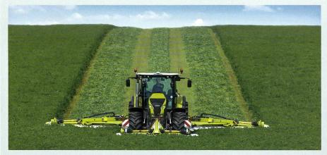
Die grösste angebaute Mähkombination mit Aufbereiter am Markt kommt demnächst aus dem Hause Claas. Das neue Scheibenmähwerk «Disco 1100 Business» erreicht eine maximale Arbeitsbreite von 10,70 m. In die Saison 2016 startet Claas zudem mit neun neuen Mähwerken für den Front- und Heckanbau zwischen 2.60 m und 3.40 m Arbeitsbreite und führt den neuen «Max Cut»-Mähbalken in nahezu allen «Disco»-Modellen ein. (Bild: Claas)
