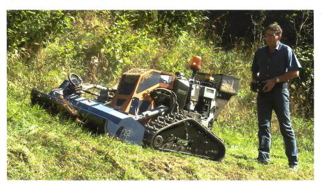
Neue, funkgesteuerte Maschinen entlasten die bedienende Person von körperlicher Arbeit und erhöhen die Sicherheit.
