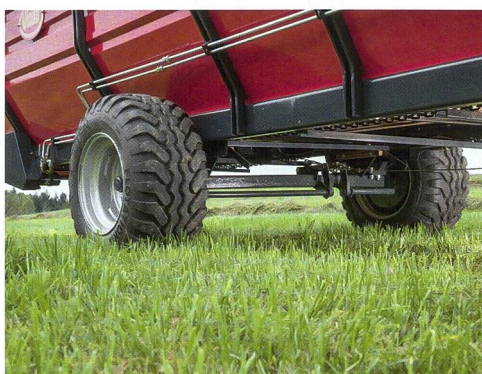
Ein bis auf die Achse abgesenktes Chassis garantiert den tiefen Schwerpunkt und sichert die Standfestigkeit in Hanglagen. (Bild: Vicon)
