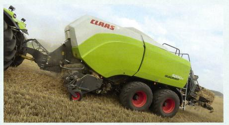
Das Ballenmass von 120×70 cm bediente Claas bisher mit den «Quadrant 3200» und «2200». Diese beiden Modelle werden durch die «Quadrant 5200» und «4200» ersetzt, die punkto Leistung, Durchsatz und Pressdichte nochmals zulegen konnten. Beide Quaderballenpressen wurden komplett überarbeitet. Dafür hat Claas sogar sein ältestes Patent angefasst und präsentiert einen neuen Hochleistungsknoter mit aktiver Garndrückersteuerung und Luftführung in der Knoterreinigung. (Bild: Roman Engeler)
