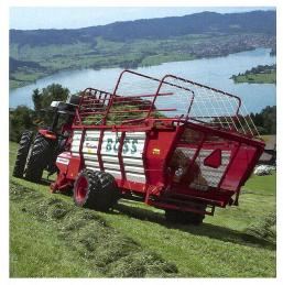
Das Fahren in Hanglagen stellt auch hohe Anforderungen an das Fahrwerk bzw. an die verwendete Bereifung. (Bild: Konrad Merk)
