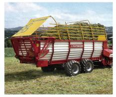
Die grossen Tieflader sind ebenso leistungsfähig wie vergleichbare Hochlader. (Bild: Pöttinger)
