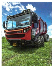
Titelbild: Muli T10 X-«Hybridshift» mit mechanischem und hydraulischem Fohrantrieb. (Bild: Roman Engeler)
