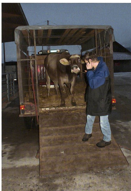
Schlechtes Beispiel: Die rutschige Rampe und das Fehlen einer seitlichen Begrenzung führten zu einer Strafanzeige.
