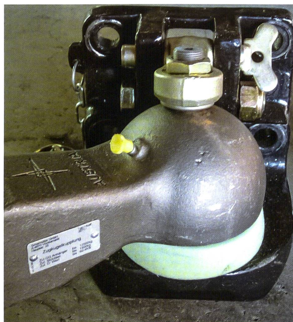
Die praktisch spielfreie K80-Kupplung muss regelmässig geschmiert werden, damit sie auch spielfrei bleibt.
