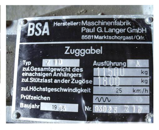
Im Strassenverkehrsgesetz (SVG) steht in Art. 303: «Fahrzeuge dürfen zum Ziehen von Anhängern nur verwendet werden, wenn Zugkraft und Bremsen ausreichen und die Anhängevorrichtung betriebssicher ist.» Weit verbreitet in der Landwirtschaft ist als Obenanhängung die Bolzenkupplung 40 mit glattem oder balligem Bolzen. Als Gegenstück eignet sich eine Zugöse mit einem Innen-Ø von 40 mm.
