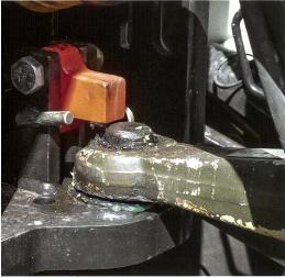
Am Pitonfix darf nur der geeignete Hitchring verwendet werden. Umgekehrt darf dieser aber nicht in der Bolzenkupplung zum Einsatz kommen (Spiel).
