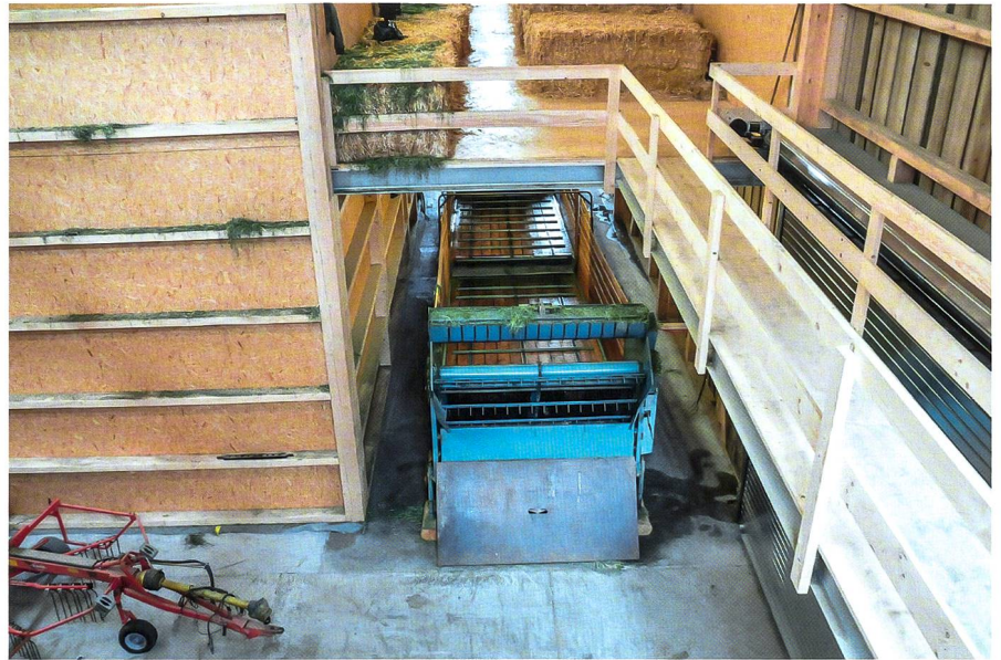
Extrem feuchtes Futter wird zur Gewährleistung einer lockeren Einfüllung durch ein Dosiergerät aufgelockert.
