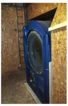
Der speziell druckstabile Ventilator benötigt eine elektrische Leistung von maximal 22 kW.
