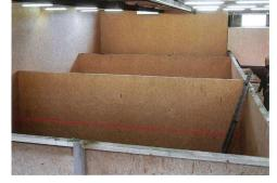
Zur Beurteilung der aktuellen Füllhöhe sind Trocknungsboxen mit gut sichtbaren Höhenmarkierungen versehen.
