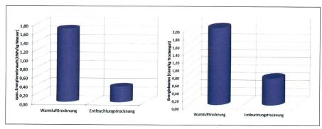
Muss das Heu bei schlechtem Wetter und hoher Luftfeuchtigkeit fertig getrocknet werden, bieten sich die Erwärmung der Ansaugluft (z.B. Schnitzelheizung) oder die Entfeuchtertrocknung an. Die Grafik zeigt am Beispiel der Getreidetrocknung, dass der spezifische Energieverbrauch pro kg Wasser mit der Entfeuchtertrocknung massiv geringer ist als bei der Warmlufttrocknung. Die Energiekosten können je nach Energieträger und Region stark abweichen.
