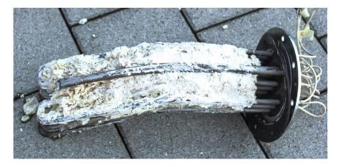
Stark verkalktes Heizregister: Eigentlich sollte man früher entkalken, denn die dicken Kalkschichten verschlechtern die Wärmeleitfähigkeit. Im obersten Rohr, wo sich die Temperaturfühler befinden, steigt gegenüber dem Zustand ohne Kalk die Temperatur und führt zu Fehlmessungen. Mit fortschreitender Verkalkung schaltet der Sicherheitsthermostat das Heizregister ab, und der Boiler bleibt kalt.
