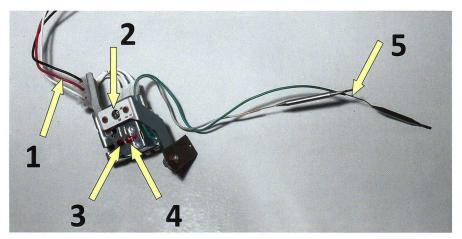
Gehäuse mit den beiden Thermostaten: 1 = Zuleitung, welche nicht zwingend demontiert werden muss. 2 = Hauptthermostat, bei welchem die Solltemperatur mit einem Schraubenzieher verstellt werden kann. 3 = Sicherheitsthermostat mit Schutzsiegel (nicht verstellbar). 4 = Entriegelungstaste des Sicherheitsthermostaten. 5 = Fühler der beiden Thermostaten.
