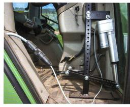
Ein Stellmotor erhält die Signale, um über das Gaspedal die Zapfwellendrehzahl zu verändern.
