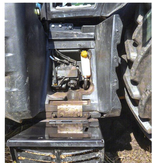
Geschützt hinter der abgeklappten Aufstiegstreppe befindet sich der Einfüllstutzen für das Hydrauliköl.
