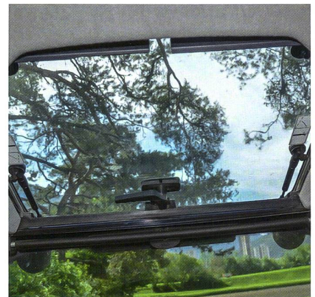
Das Dachfenster erleichtert in erster Linie die Arbeit mit dem Frontlader.
