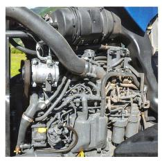
Der aufgeladene AGCO-Power-Motor holt aus 6,61-Hubraum 121 kW – mit Boost 132 kW. Er erfüllt mit SCR-Technologie die aktuellen Abgasnormen.
