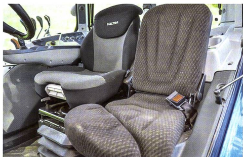
Fahrer und Beifahrer können auf einem zweckmässigen bequemen Sitz Platz nehmen. Der Fahrersitz ist luftgefedert.
