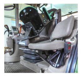
Beim John Deere Premium haben wir eine steckbare Adapterplatte angefertigt. Der Beifahrersitz lässt sich durch Lösen zweier Flügelmuttern im Nu montieren und demontieren.
