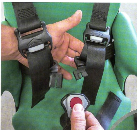
Die 5-Punkt-Gurten sind sehr praktisch und solide. Ein Verriegelungsknopf für alle Gurten, prima.
