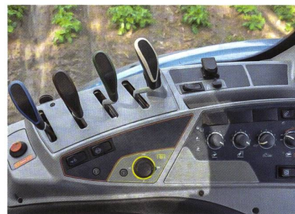
Der «Hydraulikbereich» ist überschaubar. In diesem Fall mit 4 Steuerventilen, eines mit regulierbarer Ölmenge in der Kabine.
