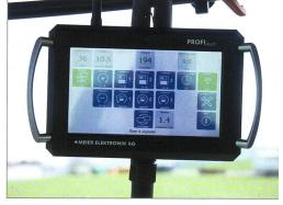
Über das 7'-Touch-Display werden sämtliche Betriebszustände der Anlagekomponenten und des Pumpenaggregats ferngesteuert kontrolliert und reguliert.
