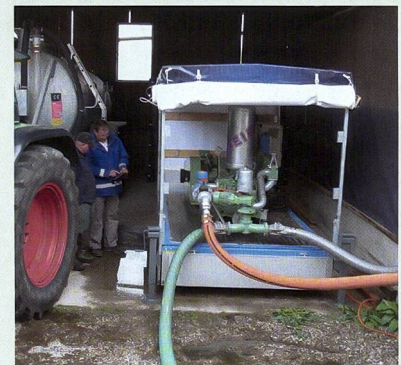
Höchste Leistungsausbeute dank elektrisch angetriebener, doppelt wirkender Kolbenpumpe. (Bilder: zVg)
