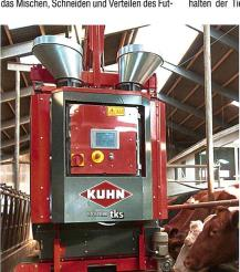
ters in einem Arbeitsgang. Die Beimischung von Kraftfutter und Konzentraten erfolgt beim Kuhn Feed Robot durch separat mitgeführte Vorratsbehälter direkt auf das Austrageband.
