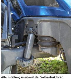
Alleinstellungsmerkmal der Valtra-Traktorer ist die pneumatische Vorderachsfederung
