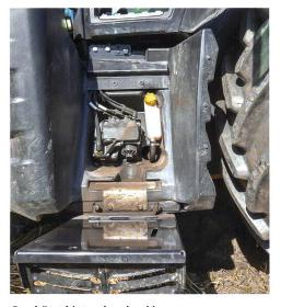
Geschützt hinter der abgeklappten Aufstiegstreppe befindet sich der Einfüllstutzen für das Hydrauliköl.
