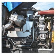
Ein leistungsfähiger Visco-Lüfter und der Kompressor für Druckluftbremse und Vorderachsfederung prägen das Bild auf der rechten Fahrzeugseite.
