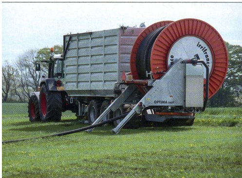
Auf Hakenfahrzeug (Multibenne) im Huckepack: Puffertank mit Hydraulikaggregaten, Förderpumpen und ProfiPilot Black Box sowie Güllerverschlauchung.
