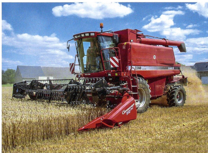
Das Harvest-Star-Klappschneidwerk von Geringhoff besitzt ein ausgeklügeltes Kupplungskonzept. (Bild: Geringhoff-Harvest-Star-878)
