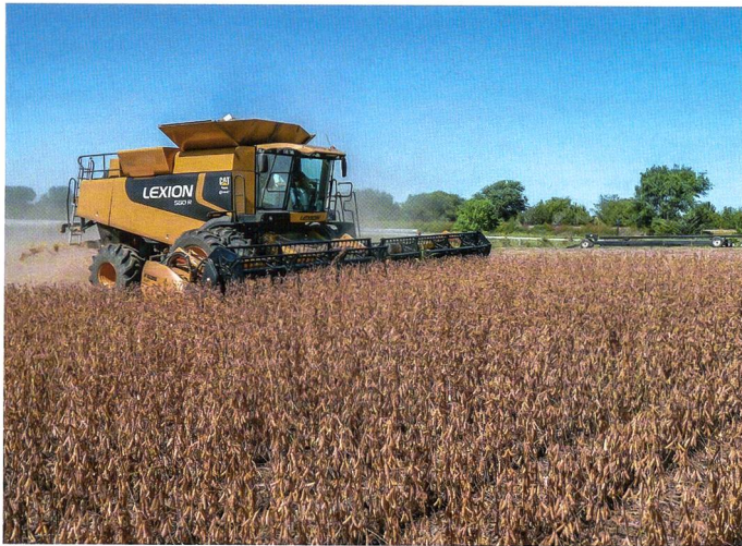
Aufgrund der niedrigen Wuchshöhe stellen Sojabohnen spezielle Anforderungen an die Boden Anpassung des Schneidwerkes.
