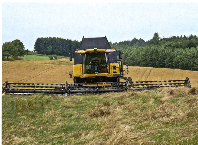
Dreiteiliges Bandschneidwerk mit grosser Arbeitsbreite und guter Bodenadaptation. (Bild: Geringhoff-TriFlex-1013)
