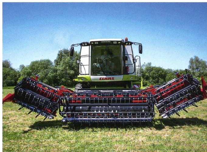
Die variable Tischverstellung stellt noch zusätzliche Herausforderungen an den Klappmechanismus. (Bild: Harvest-Star-Vario)
