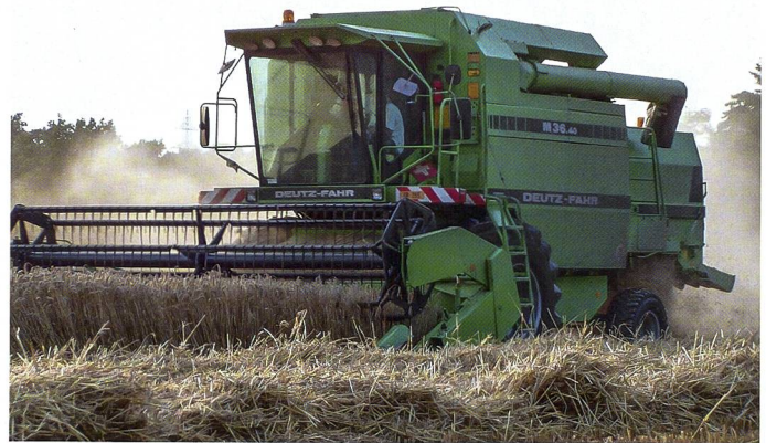
Mit einem Universalschneidwerk werden alle Getreidearten geerntet. Durch einen Umbausatz sind sie auch im Raps einsetzbar.
