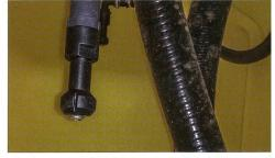
Für eine gute Feldreinigung braucht es Tankinnenreinigungsdüsen. Neue Feldspritzen werden oft damit ausgestattet, ältere Feldspritzen können mit Reinigungsdüsen nachgerüstet werden.
