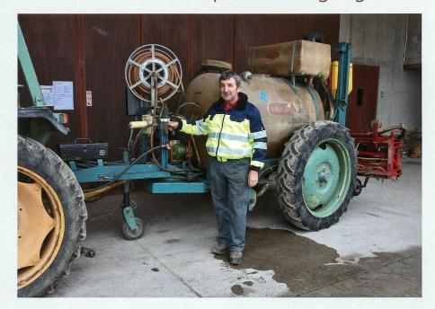
René Heller, Landwirt aus Unterstammheim, reinigt seine Anhängerspritze (1600 lt) seit über dreissig Jahren auf dem Feld. Dazu hat er die Spritze mit einem 200-Liter-Spülwassertank und einer Tankinnenreinigungsdüse nachgerüstet. Zudem hat er den Rücklauf mittels Dreiweghahn mit der Ansaugleitung verbunden. «In der Regel reinige ich drei- bis viermal ohne Reinigungsmittel auf dem Feld», sagt René Heller. Wichtig sei, dass nach dem letzten Spülvorgang der Rücklauf
