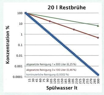
Eine einzige Spülung mit der gesamten Spülwassermenge reduziert zwar die Restkonzentration, mehrere Spülungen mit kleineren Wassermengen sind aber wirksamer. Bei der kontinuierlichen Reinigung wird fortlaufend gereinigt und gleichzeitig ausgespritzt. Mit der vorhandenen Wassermenge kann gründlicher gereinigt werden als mit dem abgesetzten Verfahren.
