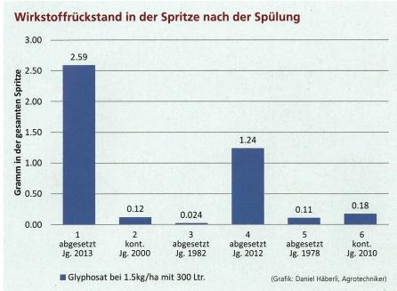
spritze des Strickhofs, die anderen fünf waren Feldspritzen. Die Fischerspritze mit Baujahr 2013 ist die Spritze von Agroscope in Tänikon, sie verfügt über keinerlei Tankinnenreinigungsdüsen.
