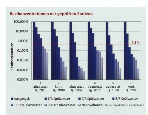
Zusatzinformationen: 1 manuelles abgesetztes Reinigungsverfahren ohne Tankinnenreinigungsdüsen – 2 kontinuierliche Innenreinigung (Gebläsespritze) – 3 manuelles abgesetztes Reinigungsverfahren – 4 automatisiertes abgesetztes Reinigungsverfahren – 5 manuelles abgesetztes Reinigungsverfahren – 6 kontinuierliche Innenreinigung
