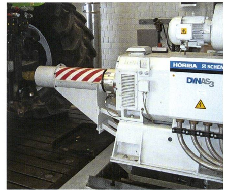
Der Zapfwellenprüfstand HD 600 liefert Leistungs- und Verbrauchskennzahlen bis max. 600 kW Leistung; die Verbrauchsmessung erfolgt gravimetrisch.
