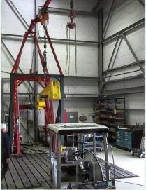
Der Testaufbau FOPS-Prüfung mit einer 44-kg-Kugel.
