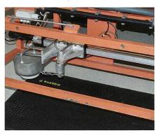
Das Messgerät für die Rutschfestigkeit von Matten im Kuhstall.
