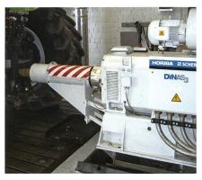
Der Zapfwellenprüfstand HD 600 liefert Leistungs- und Verbrauchskennzahlen bis max. 600 kW Leistung; die Verbrauchsmessung erfolgt gravimetrisch.
