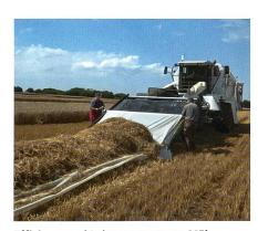
Effizienz- und Leistungstests am Mähdrescher; das auf die Doppelfolie abgelegte Stroh wird begutachtet.
