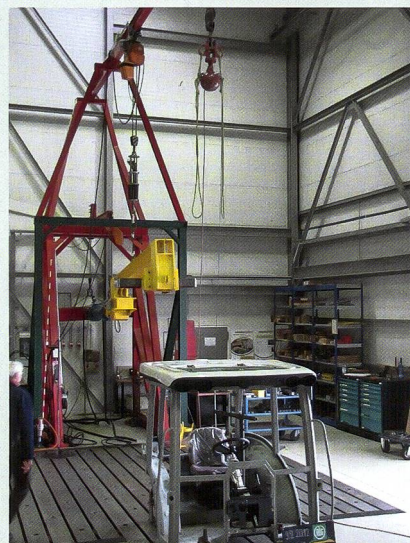
Der Testaufbau FOPS-Prüfung mit einer 44-kg-Kugel.
