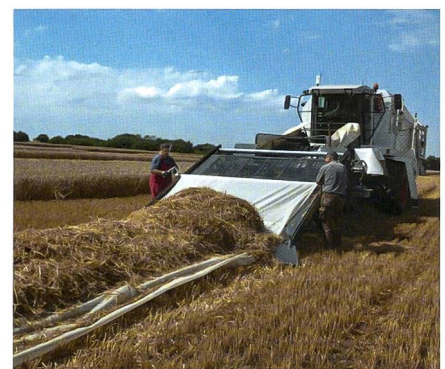
Effizienz- und Leistungstests am Mäh-drescher; das auf die Doppelfolie abgelegte Stroh wird begutachtet.
