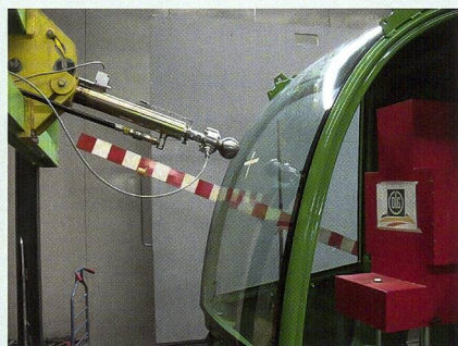
Bei der OPS-Prüfung (Operator Protective Structure) wird nach Normvorgabe die Scheibe oder das Schutzgitter mittels Hydraulikzylinder belastet.
