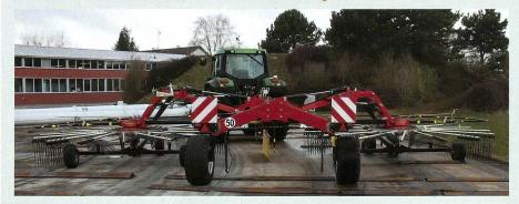
Schwader im Härtetest auf dem Rundlauf des DLG-Testzentrums Technik und Betriebsmittel.
