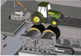
In Zukunft steht der Traktor auf vier Stahlrollen mit jeweils zwei Metern Durchmesser, die von Elektromotoren angetrieben werden.
