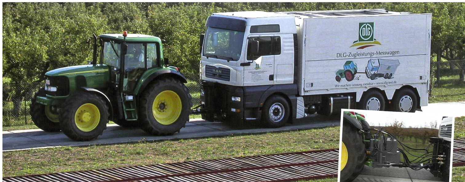
Das Gespann mit Messwagen und der Power-Mix-Einheit (kleines Bild) für die Zugleistungsmessung, im Vordergrund die Spezialpiste für Sitzschwingungs- und Vibrationsmessungen. (Bilder: DLG/Dominik Senn)
