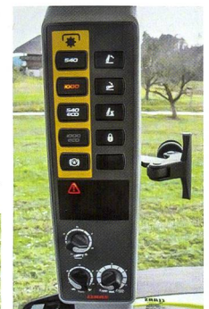
Im rechten A-Holm befindet sich ein zweites Display, das über die wichtigsten Getriebefunktionen wie vorgewählte Gänge informiert.
