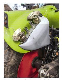
Die Halterungen für vier Kugeln befinden sich auf dem sehr gut zugänglichen Behälter für das Scheibenwischerwasser.
