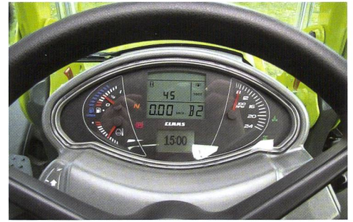
Aufgrund der idealen Form und der geringen Distanz sind die Anzeigen durch das Lenkrad hindurch jederzeit gut sichtbar.
