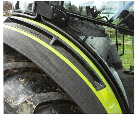
Die Ansaugöffnungen für die Kabinenlüftung sind in die Kotflügel integriert.
