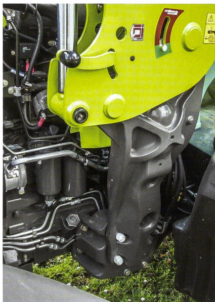
Die Frontladerkonsolen werden direkt an die massive Ölwanne geschraubt.
