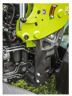
Die Frontladerkonsolen werden direkt an die massive Ölwanne geschraubt.
