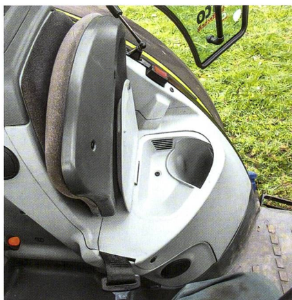
Unter dem Beifahrersitz befindet sich ein gekühltes Fach für eine 1,5-l-Flasche und Snacks.
