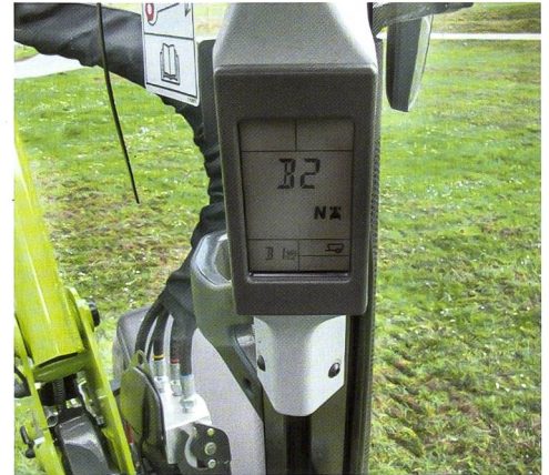
Im rechten A-Holm befindet sich ein zweites Display, das über die wichtigsten Getriebefunktionen wie vorgewählte Gänge informiert.
