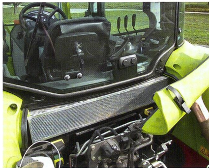
Der Kabinenluftfilter ist unter der Heckscheibe auch für klein gewachsene Personen mühelos zugänglich.
