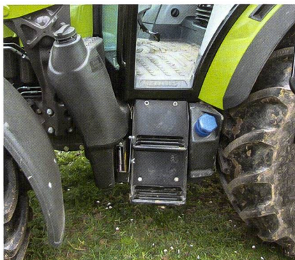
Beim linken Einstieg sind auch der Dieseltank, der Adbluetank (blau) und ein Unterlegekeil untergebracht.
