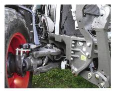
Hier sind das Frontchassis mit Wespentaillenform und die gefederte Vorderachse zu sehen.
